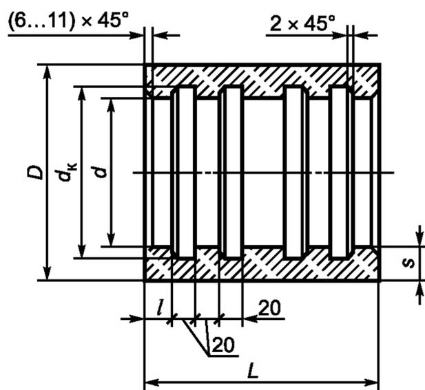
$D$  — наружный диаметр трубы;  $d$  — внутренний диаметр трубы;  $d_k$  — внутренний диаметр канавки
