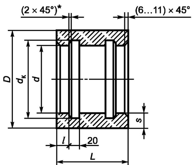
$D$  — наружный диаметр трубы;  $d$  — внутренний диаметр трубы;  $d_k$  — внутренний диаметр канавки
