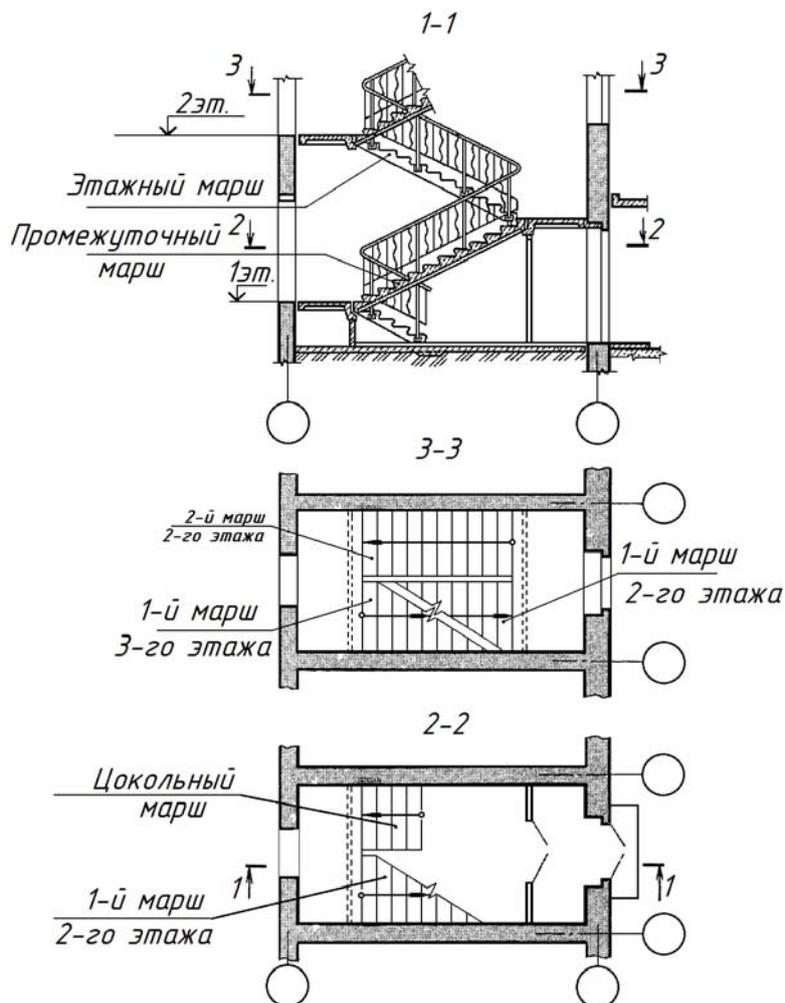
Рис. 6.3.2. Разрез лестничной клетки
