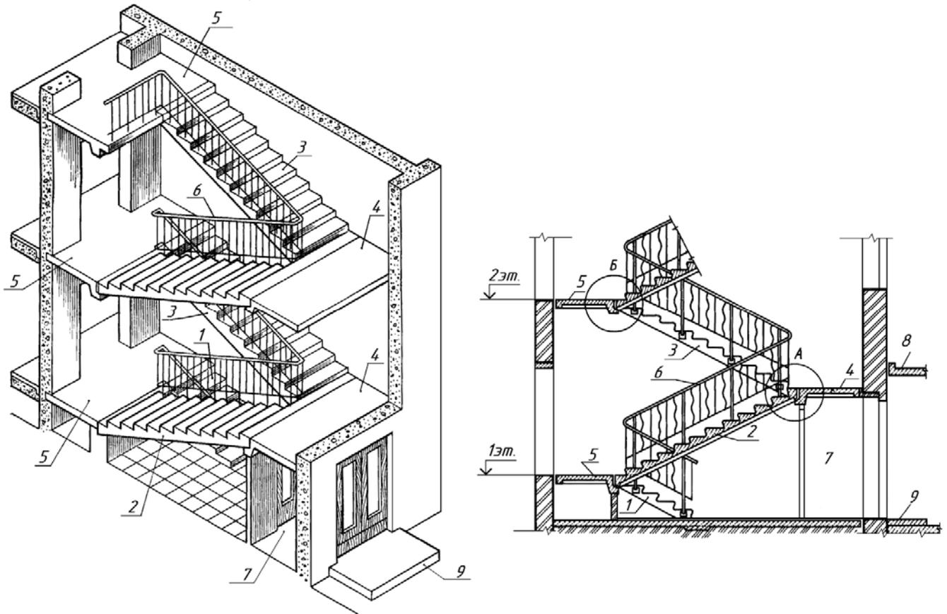
Рис. 6.2.1. Общий вид и разрез лестничной клетки
