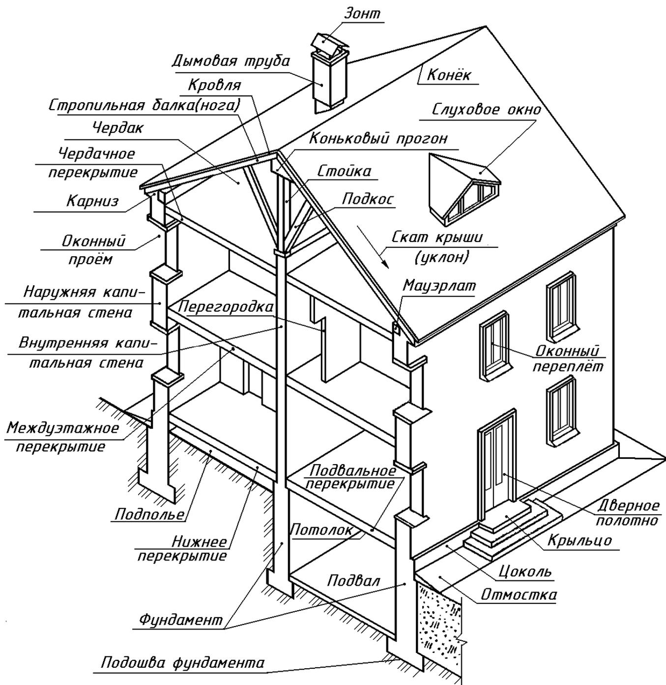
Рис. 4.3. Здание со стропильной крышей
