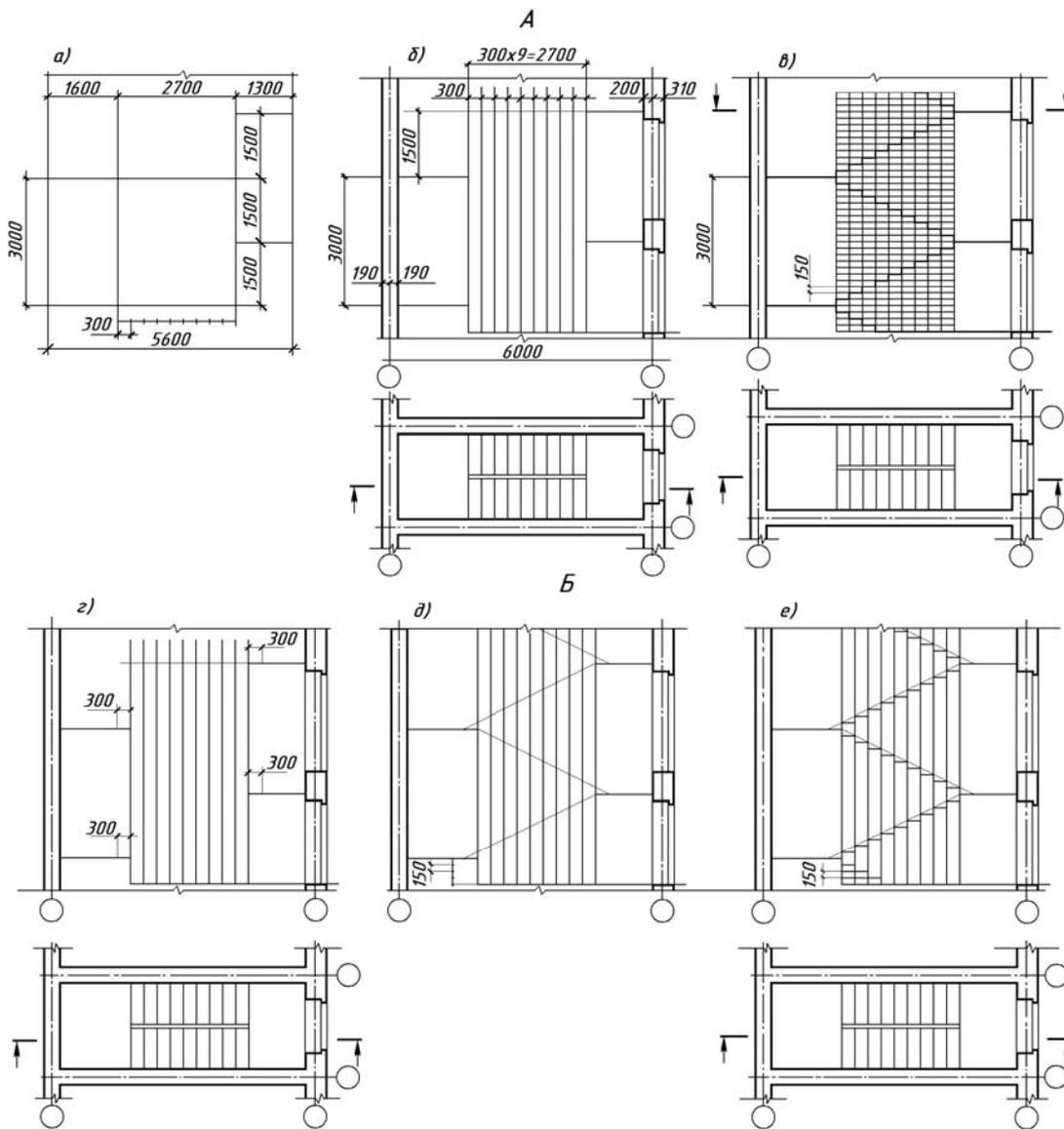
Рис. 6.3.1. Графическая разбивка лестничной клетки
