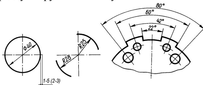
Рис. 3.1. Случаи применения стрелок на размерных линиях
