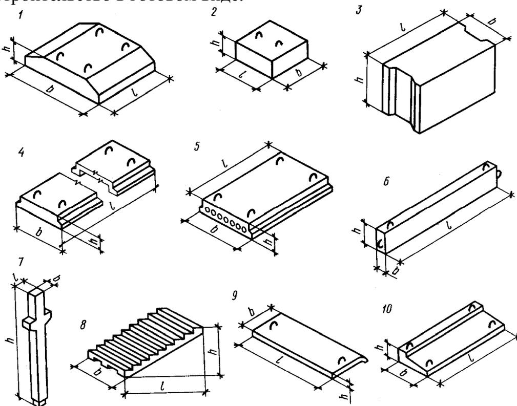
Рис. 4.1. Типовые железобетонные изделия
