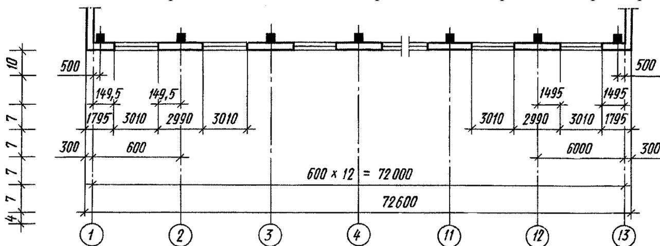
Рис. 3.3. Простановка размеров на планах зданий
