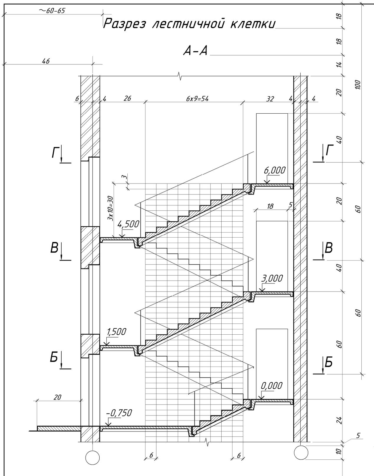
Рис. 6.3.5 Разрез для входа слева
