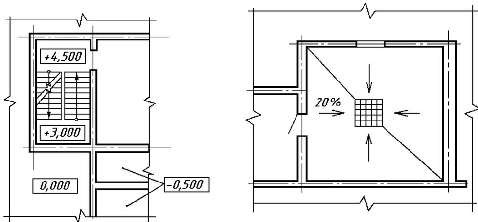
Рис. 3.6. Простановка отметок на планах
