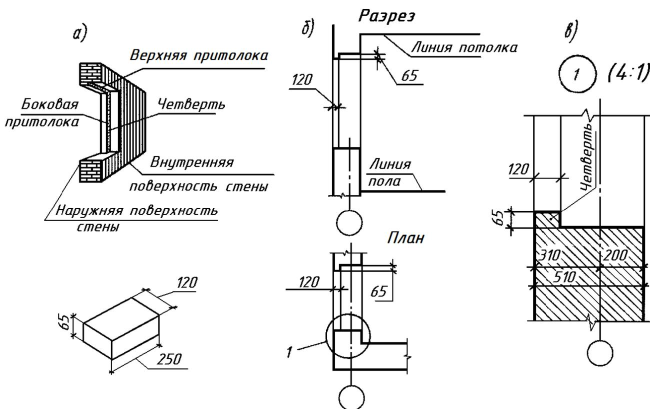
Рис. 6.4.1. «Четверть» и её изображение на чертеже
