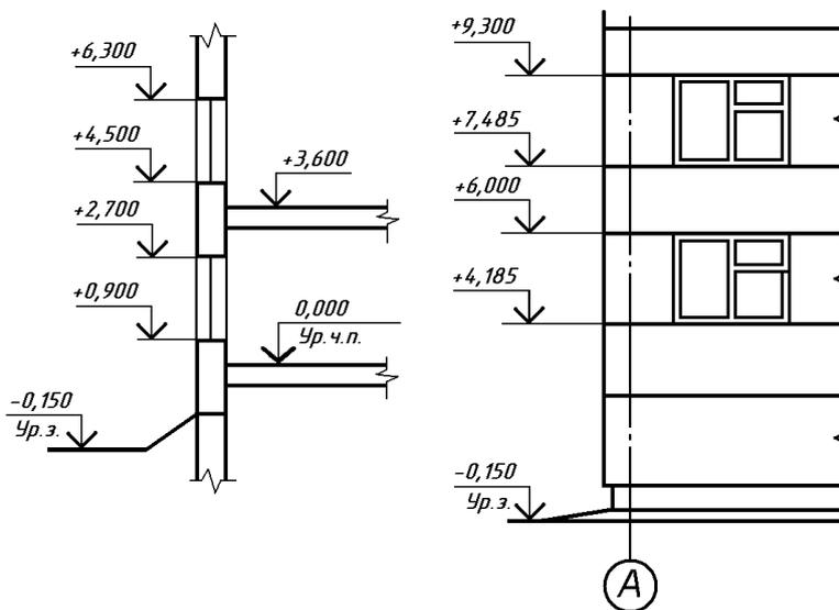
Рис. 3.5. Простановка отметок на разрезах и фасадах
