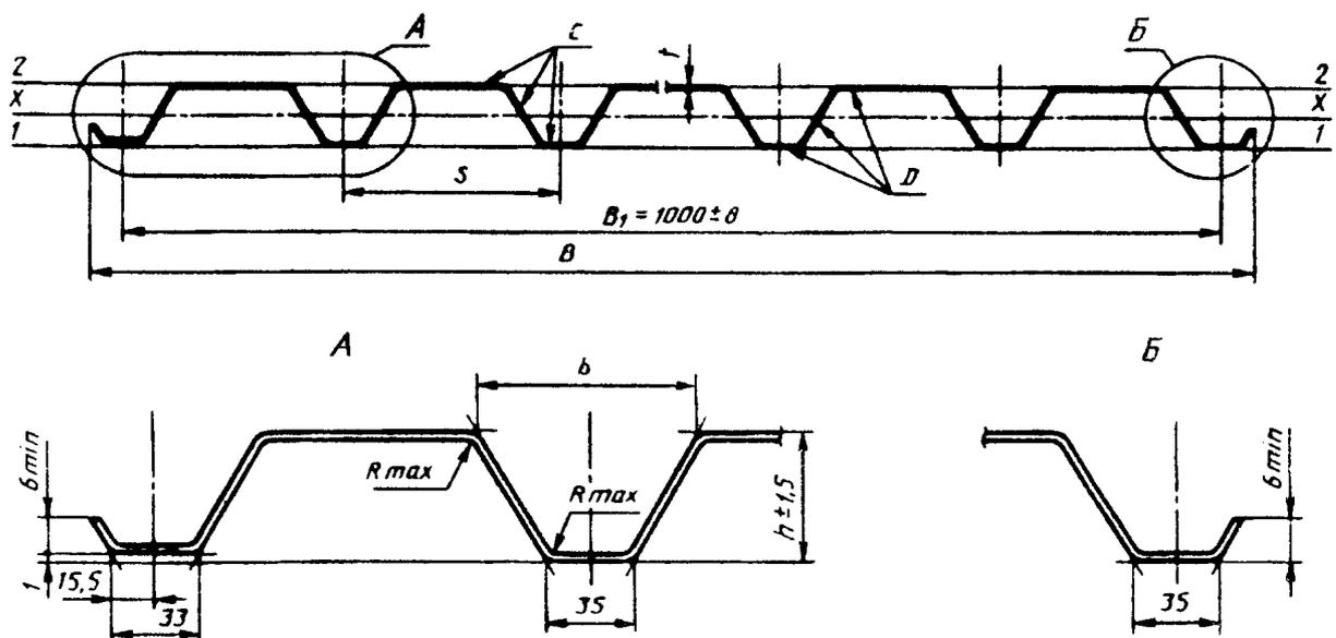
Рисунок 9 - Профилированный лист типа С высотой 21 и 44 мм
