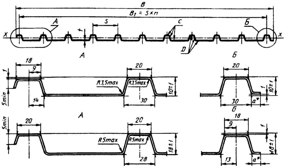
Рисунок 7 - Профилированный лист типа С высотой 10 и 18 мм
