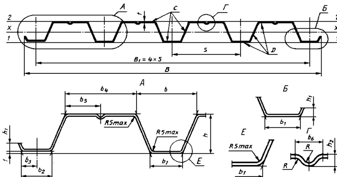
Рисунок 1 - Профилированный лист типа Н высотой 57 и 60 мм
