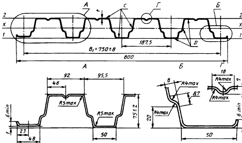
Рисунок 2 - Профилированный лист типа Н высотой 75 мм
