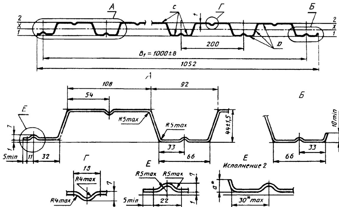
Рисунок 6 - Профилированный лист типа НС высотой 44 мм
