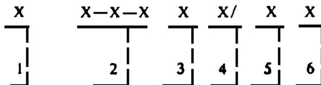
1 - тип профилированного листа (3.1.1); 2 - размеры в миллиметрах (высота h, ширина В<sup>1</sup> и толщина t); 3 - материал исходной заготовки (3.1.2); 4 - обозначение лакокрасочного покрытия листа по поверхности С (3.1.3, черт. 1-9); 5 - обозначение лакокрасочного покрытия листа по поверхности Д (3.1.3, рис. 1-9); 6 - обозначение настоящего стандарта.
