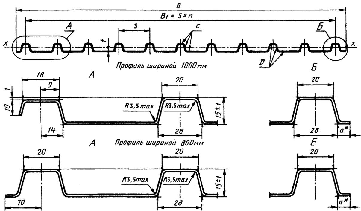
Рисунок 8 - Профилированный лист типа С высотой 15 мм
