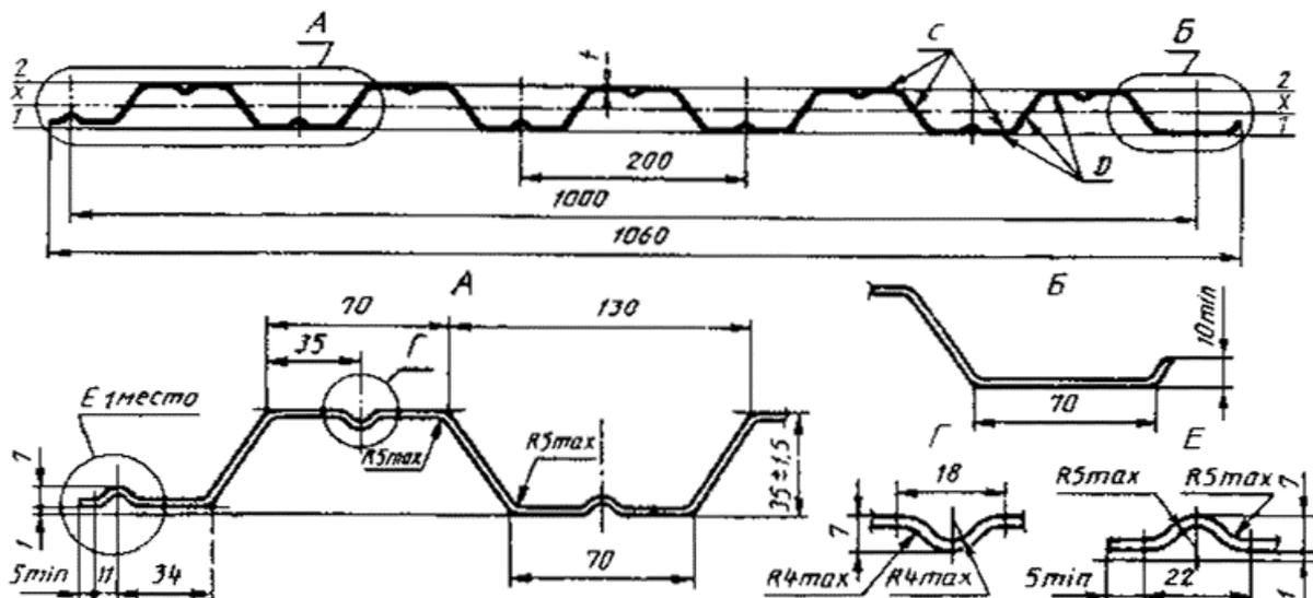
Рисунок 5 - Профилированный лист типа HC высотой 35 мм
