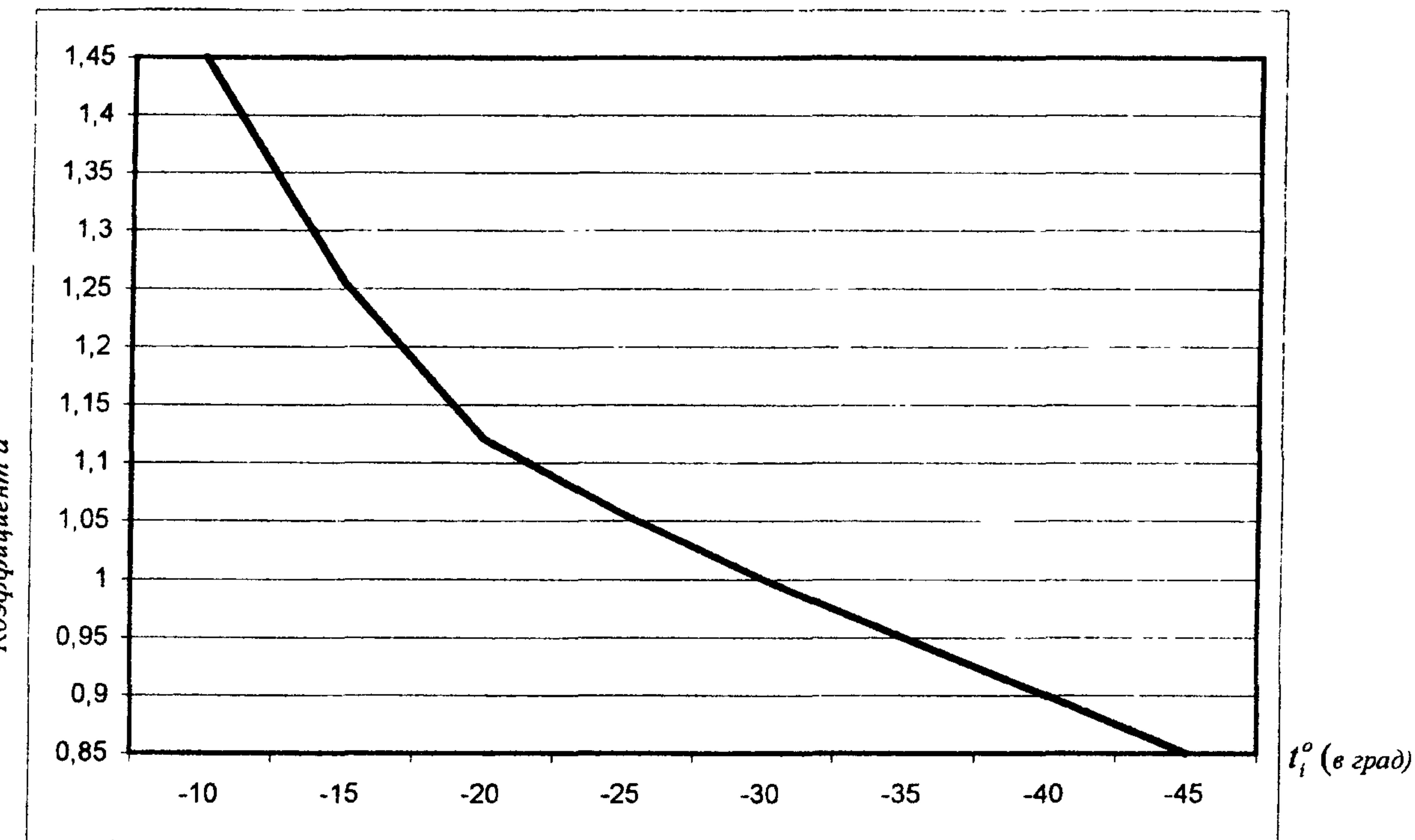
При определении расхода тепла на централизованное горячее водоснабжение  $Q_r$  по укрупненным показателям необходимо учитывать продолжительность максимального разбора воды  $Z_{\max}$  в часах в течение суток с коэффициентом часовой неравномерности потребления воды  $b$  и нормы потребления на одного человека
