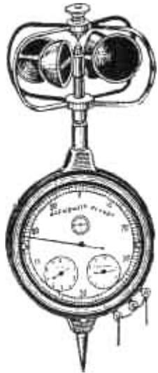
**Рис. 26.6.** Чашечный анемометр.
