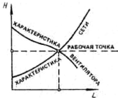
Рис. 5.7. Совмещение характеристики вентилятора с характеристикой сети.
