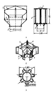
а – ЦАГИ: 1 – колпак; 2 – обечайка; 3 – конус; 4 – диффузор; 5 – шахта; 6 – остроугольный: 1 – фланец; 2 – диффузор; 3 – колпак; 4 – корпус; 5 – лапка; в – звездообразный: 1 – колпак; 2 – корпус; 3 – косынка для крепления к трубе
