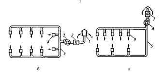
а – общий вид: 1 – воздухоприемное устройство; 2 – калорифер; 3, 4 – соответственно приточный и вытяжной вентиляторы; 5, 6 – соответственно вытяжные и приточные воздуховоды; 7 – фильтр (пылеуловитель); 8, 9 – соответственно приточные и вытяжные вентиляционные насадки; 6 – схема работы приточной части системы вентиляции; 8 – схема работы вытяжной части системы вентиляции ции
