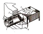
1 – вентилятор; 2 – вытяжная труба; 3 – стол сварщика; 4 – стена
