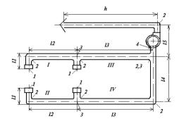
Рисунок 9 - Схема к расчёту вытяжной сети системы вентиляции:
