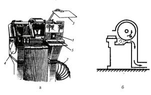
а – общий вид: 1 – абразивный круг; 2 – воздуховод; 3 – щиток; 4 – защитный кожух; 5 – подручник; 6 – схема работы
