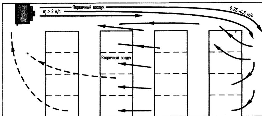
Рис. 2.7. Режим потока в холодильной камере (пример)
