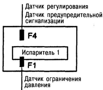
Рис. 4.78. Компоновка датчиков у охлаждаемых объектов с одним испарителем, подлежащим оттаиванию путем нагревания электричеством/горячим газом
