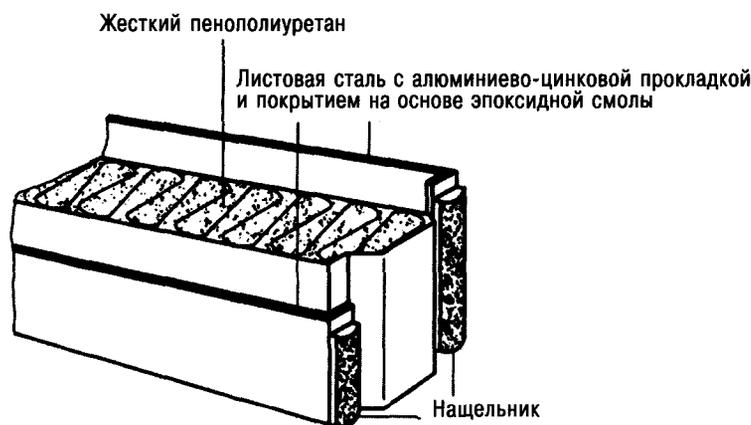
Рис. 2.3. Структура элементов стен и потолка
