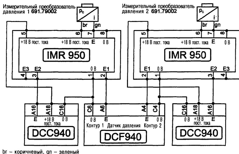
**Рис. 4.75.** Контроль давления конденсации в сочетании с DCF 940 и DCC 940. Два объединенных цикла с общим регулятором давления конденсации DCF 940 и двумя (отдельно для каждого контура) регуляторами давления всасывания DCC 940
