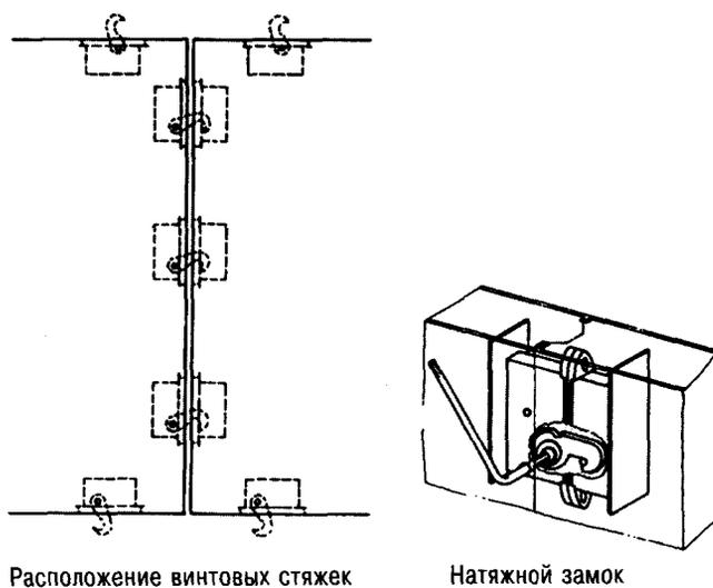
Рис. 4.8. Натяжной замок
