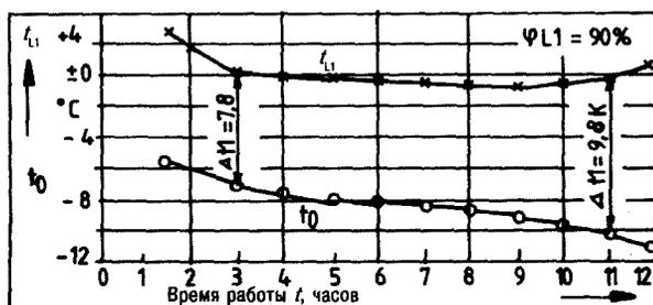
Рис. 2.12. Испаритель, рассчитанный на толстую снеговую шубу
