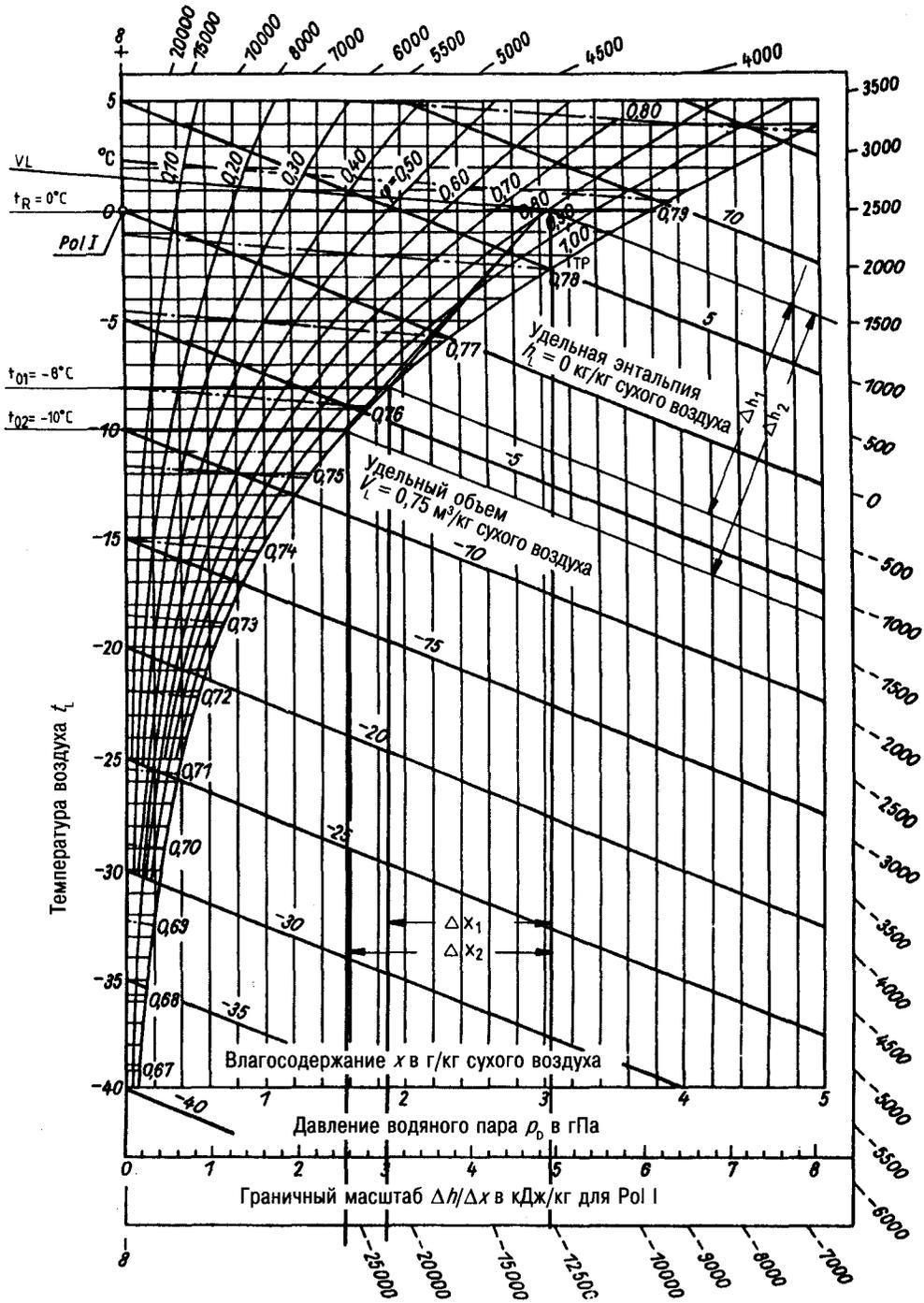
Рис. 2.13. Из  $h,x$ -диаграммы Моляе для влажного воздуха при  $P = 0,1$  МПа (по данным А. Цвиккера)
