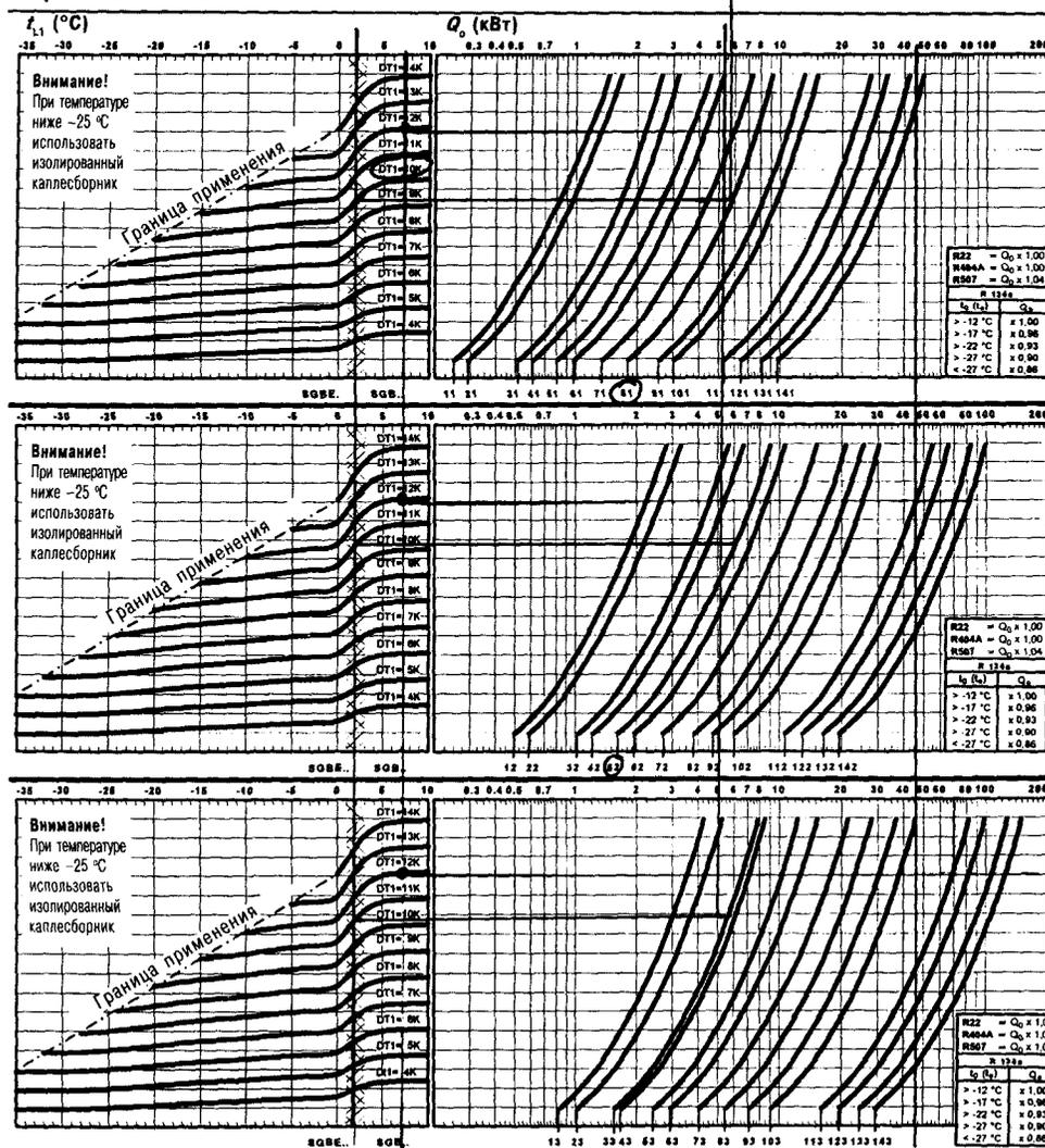
**Рис. 4.16.** Диаграмма предварительной производительности Q<sub>v</sub> (R22, R134a, R404A, R507)
