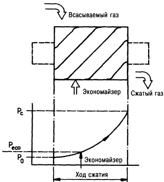
При таком конструктивном исполнении на основе цикла переохлаждения заметно повышается как холодопроизводительность, так и КПД всей системы. В отличие от обратного принципа действия поршневого компрессора, процесс сжатия в случае винтового компрессора осуществляется исключительно в направлении течения.
