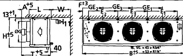
Рис. 2.46. Таблица параметров воздухоохладителя Küba SGBE 93.
