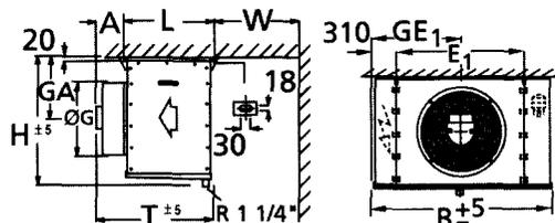
Размер паковки по высоте H = 1290 мм, по ширине B = 2144 мм, по глубине T = 1200 мм. Ссылки на исполнение с учетом отклонений от заданных размеров в разных вариантах и опциях приведены в каталоге. Просим также соблюдать наши общие указания по монтажу и эксплуатации. Если для регулирования числа оборотов используется преобразователь частоты, необходимо выполнять соответствующие предписания.
