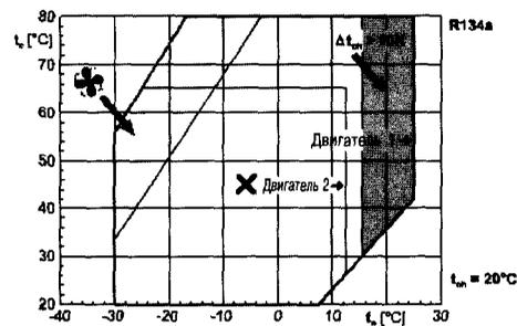
\* При 2КС-05.2 – 4СС-6.2: по ЕН 12900 (температура инжектируемого газа 20°C, переохлаждение жидкости – есть).
