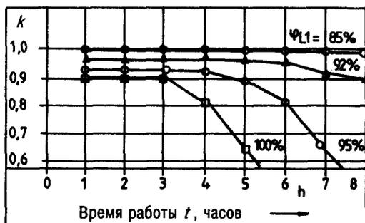
Рис. 2.9. Зависимость коэффициента теплопередачи ( $k$ ) от относительной влажности воздуха  $\varphi_{L1}$  на входе и продолжительности работы испарителя  $t$  (1,0 соответствует значению при сухом состоянии пластины)
