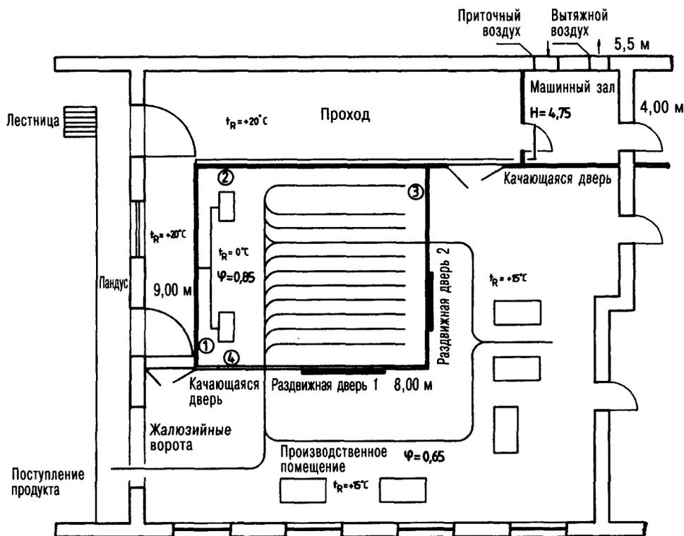
Рис. 4.11. Камера для охлаждения мяса внутри здания
