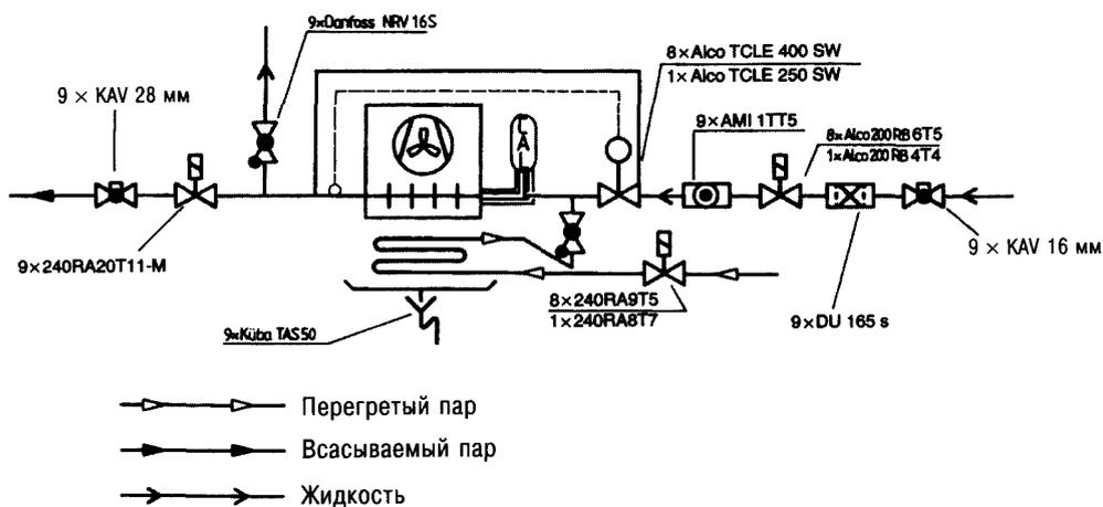
Рис. 4.54. Элементы системы управления и контроля испарителей
