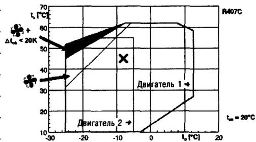
Рис. 2.47. Таблица параметров для расчета компрессора. Расчет полугерметичного поршневого компрессора (окончание)
