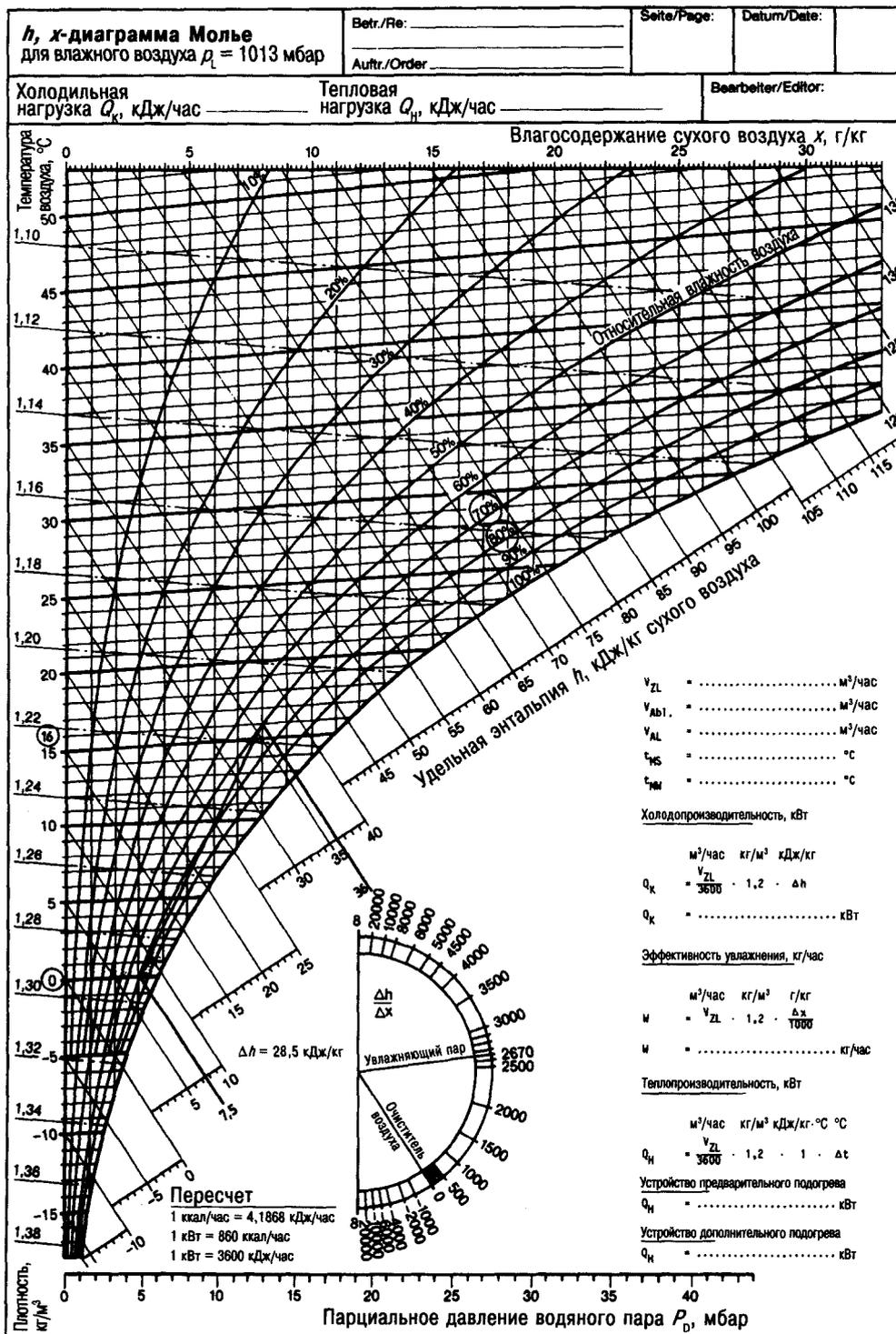
Рис. 2.4. h,x-диаграмма Молье (источник: Техника кондиционирования фирмы Вайс)
