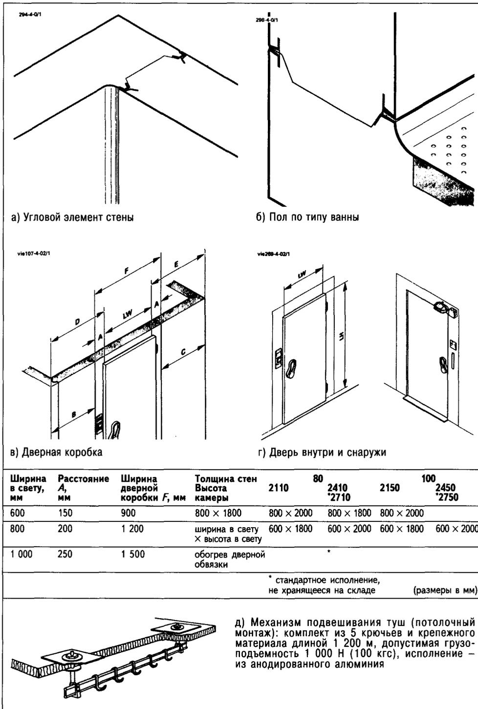
Рис. 4.9. Сборка камеры в чертеже общего вида
