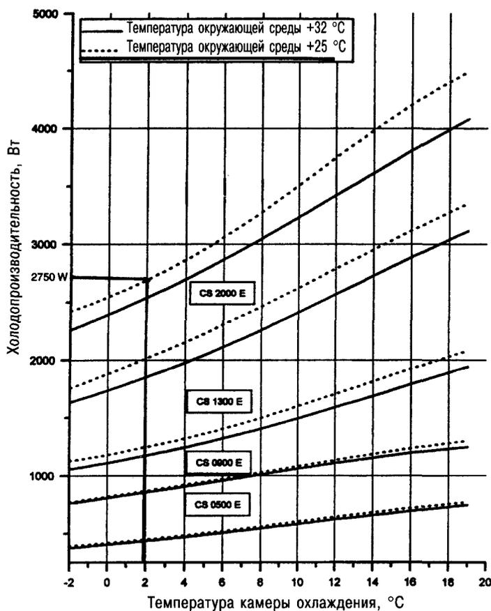
Рис. 4.10. Определение холодопроизводительности камеры охлаждения
