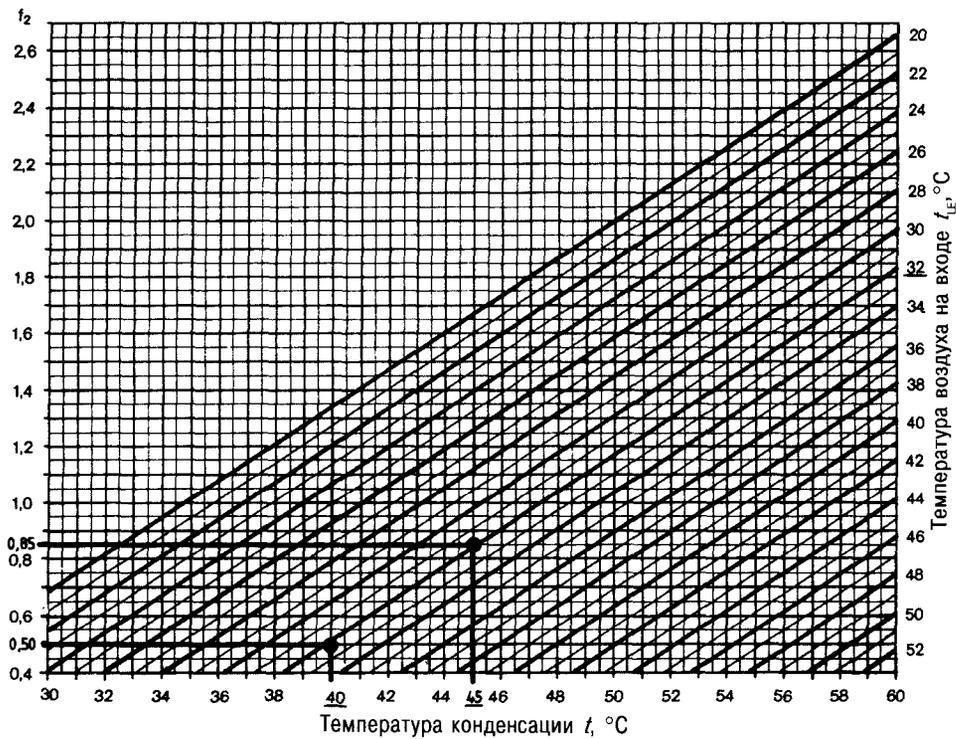
Рис. 2.41. Поправочные коэффициенты для температуры воздуха на входе
