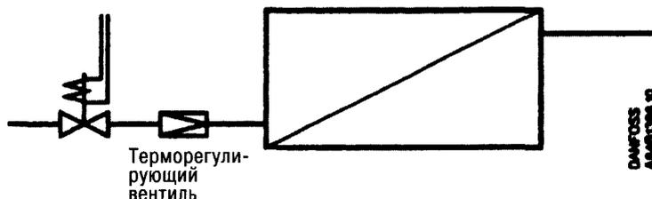
Рис. 4.57. Функция терморегулирующего вентиля (не серии «А»)
