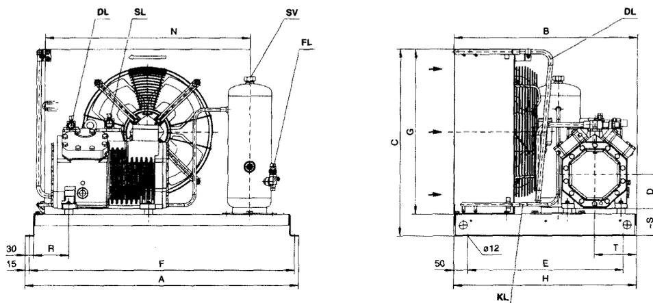
Рис. 4.22. Стандартная конденсаторная группа LH64/4FC-3.2(Y) ... LH84/4DC-5.2(Y) / LH84/4CC-6.2(Y)
