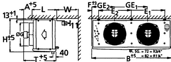
Рис. 2.18. Таблица параметров воздухоохлаждателя Küba SGLE 81.
