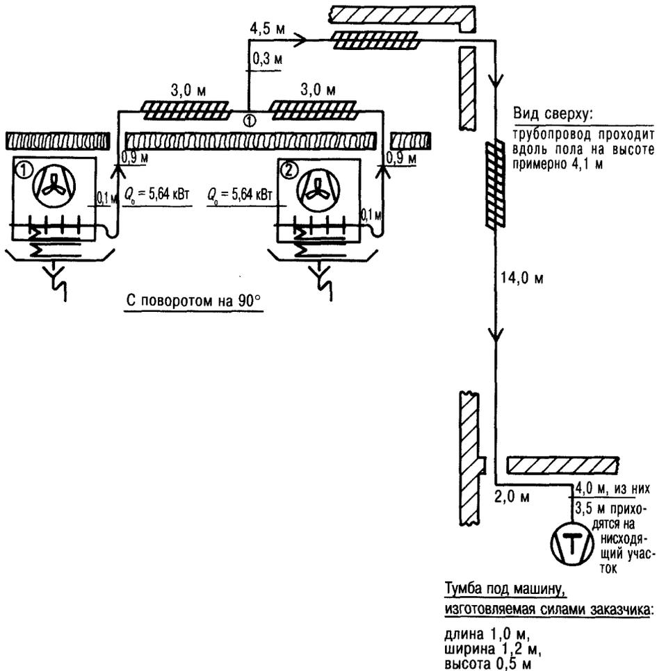
Рис. 4.24. Определение параметров всасывающего трубопровода
