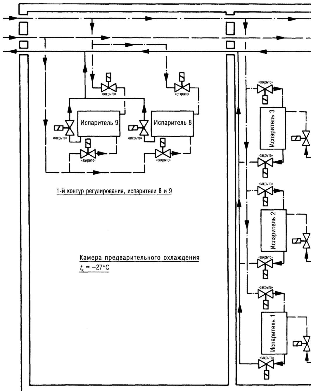
**Пример:** контур регулирования 2 в режиме оттаивания с применением горячего газа, контуры 1, 4 и 3 включены на режим охлаждения! (обозначения на соответствующих электромагнитных клапанах: «открыто»/«закрыто»)
