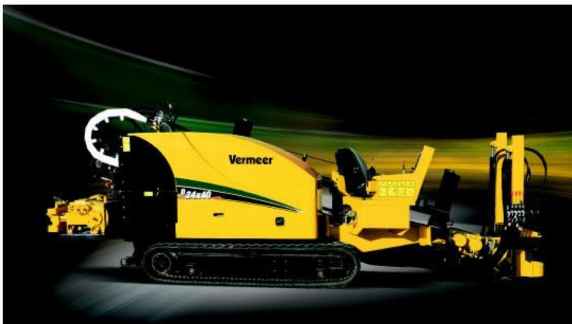
Рисунок 6.4 – Установка горизонтально-направленного бурения D24X40 СЕРИИ II
