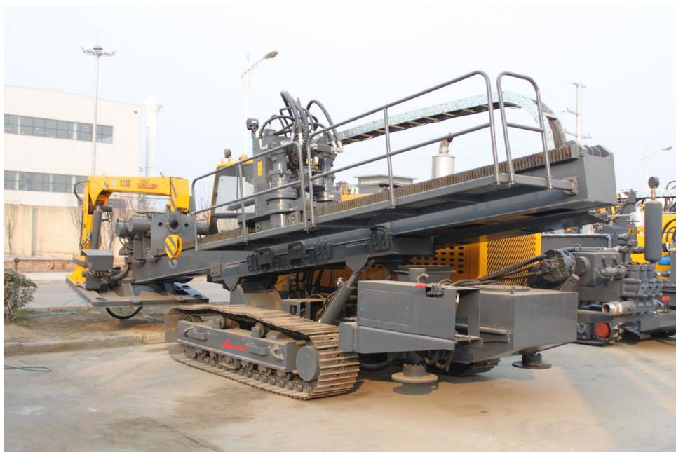
Рисунок 2.7 – Установка горизонтально-направленного бурения XZ-500 (вид сзади)
