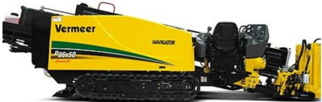
Рисунок 6.5 – Установка горизонтально-направленного бурения D36X50 SERIES II
