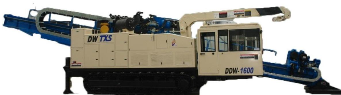
Рисунок 1.8 – Установка горизонтально-направленного бурения DDW-1600
