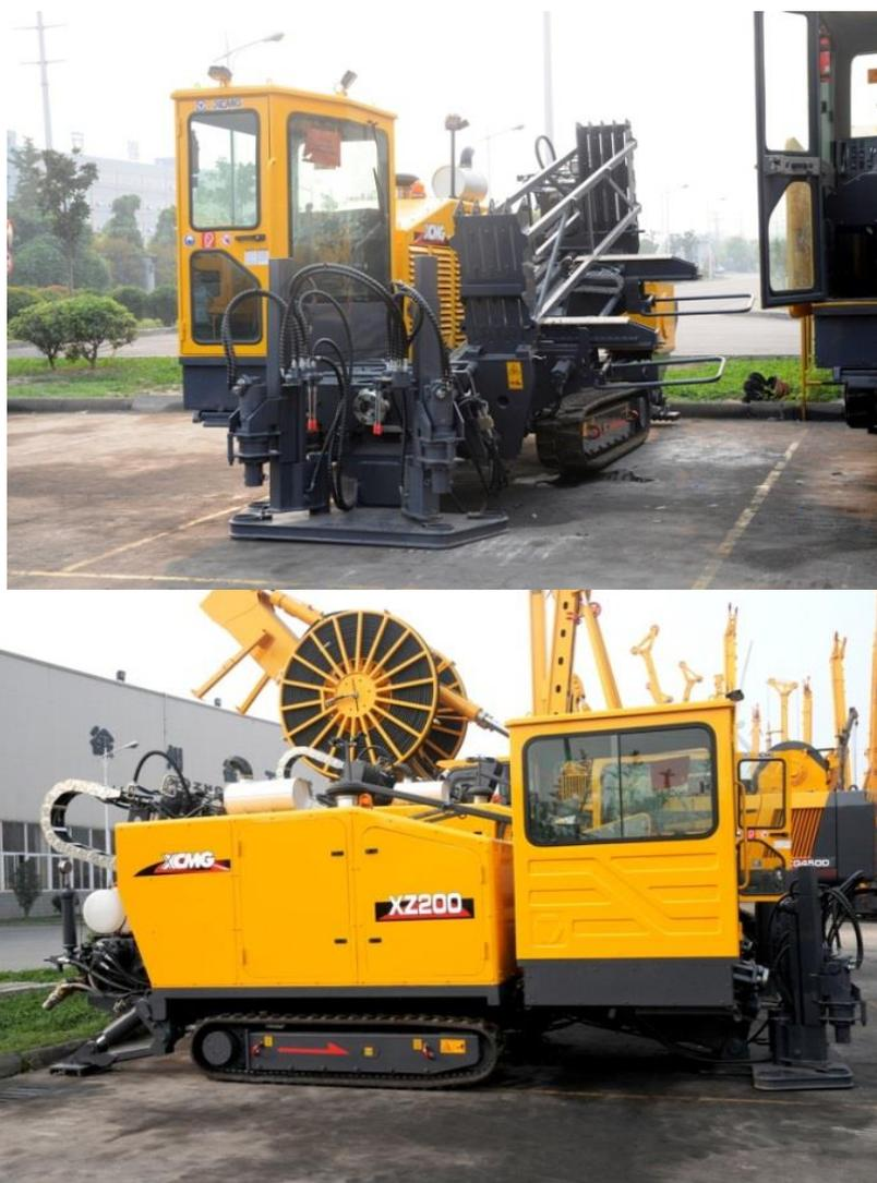
Рисунок 2.2 – Установка горизонтально-направленного бурения XZ-200
