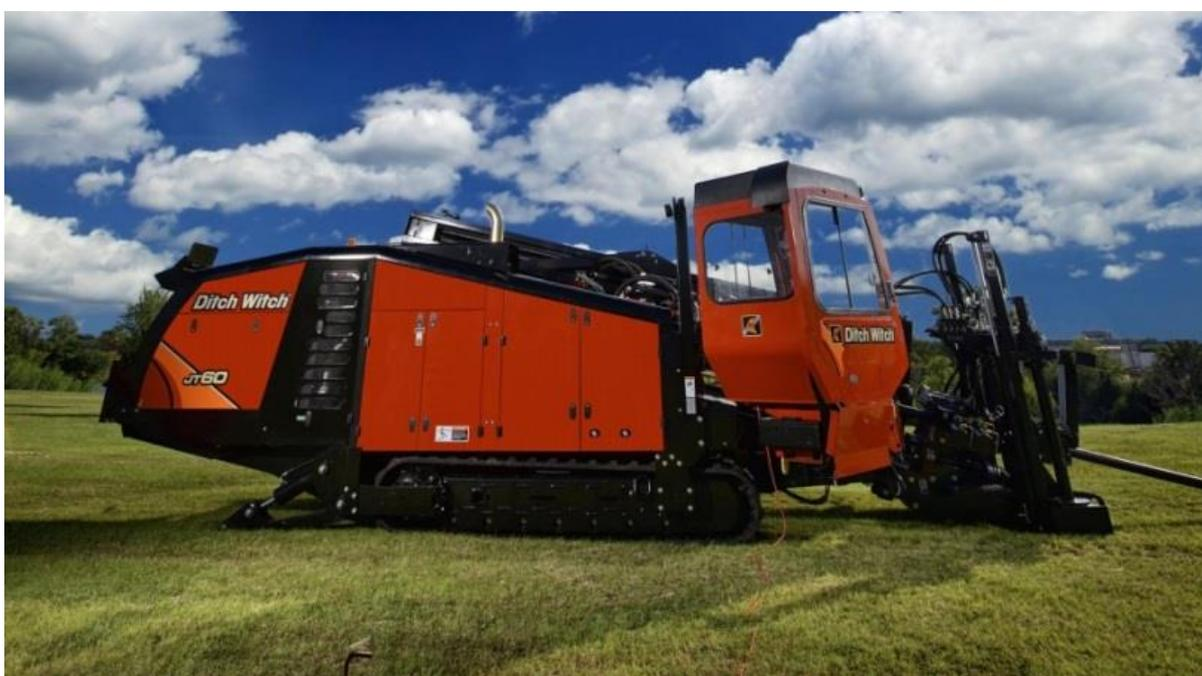
Рисунок 3.8 – Установка горизонтально-направленного бурения JT-60
