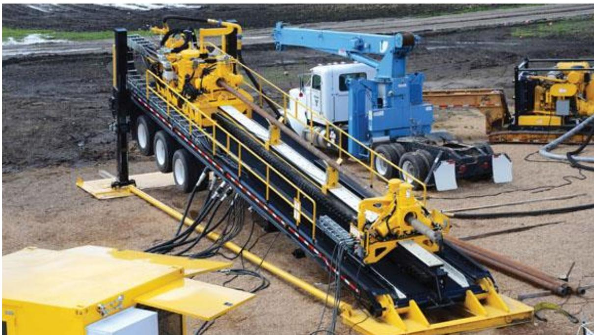
Рисунок 6.12 – Установка горизонтально-направленного бурения D500X500
