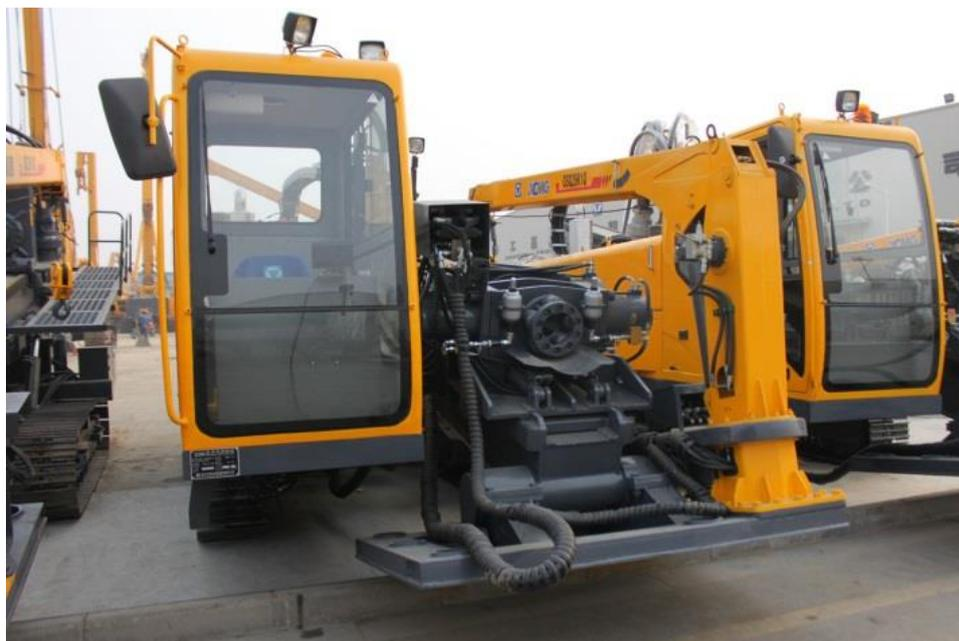
Рисунок 2.6 – Установка горизонтально-направленного бурения XZ-500
