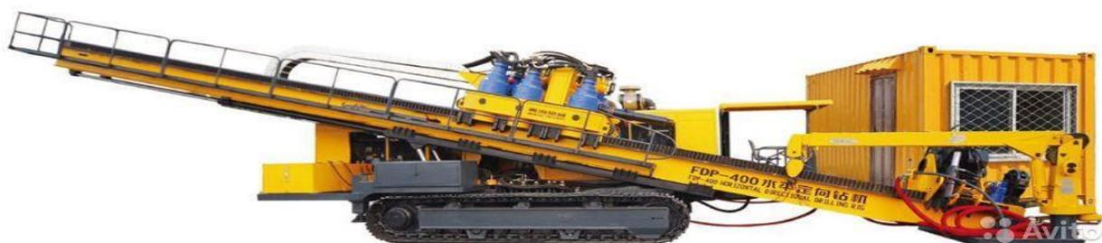
Рисунок 4.7 – Установка горизонтально-направленного бурения FDP-400
