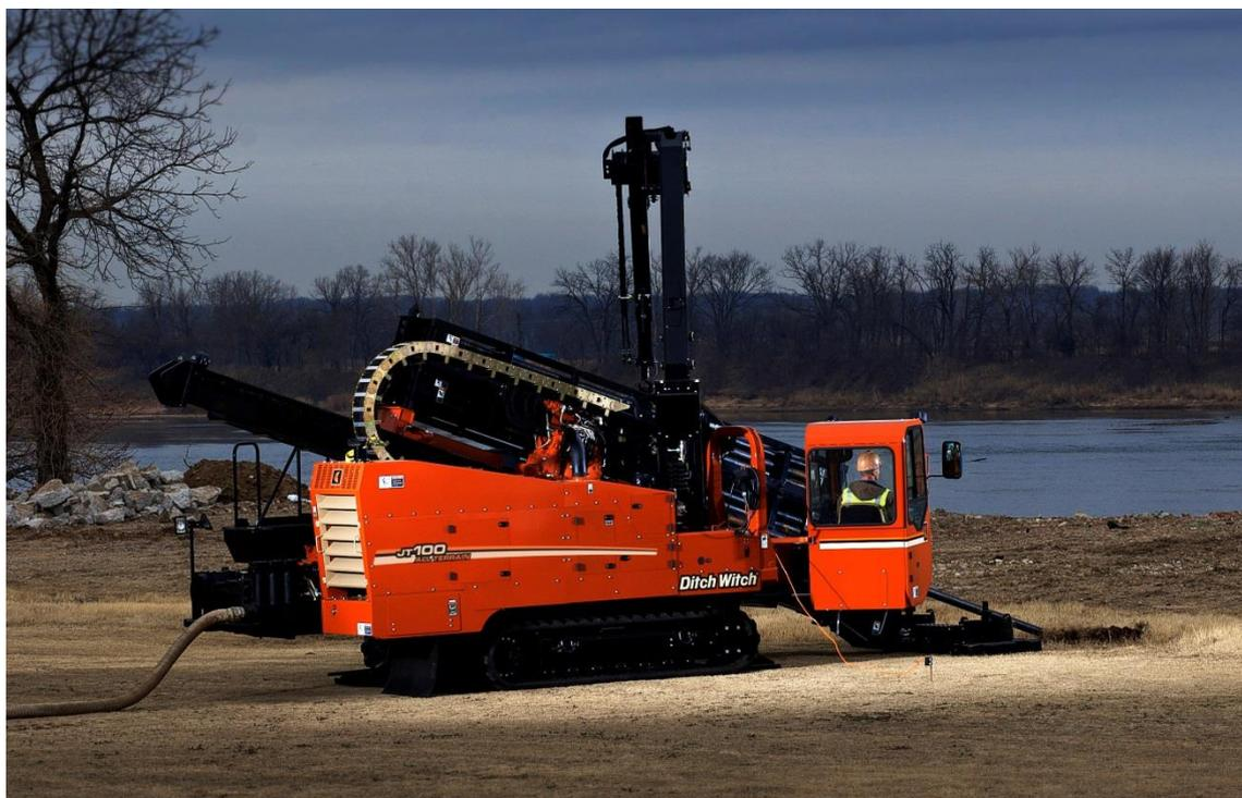
Рисунок 3.9 – Установка горизонтально-направленного бурения JT-100
