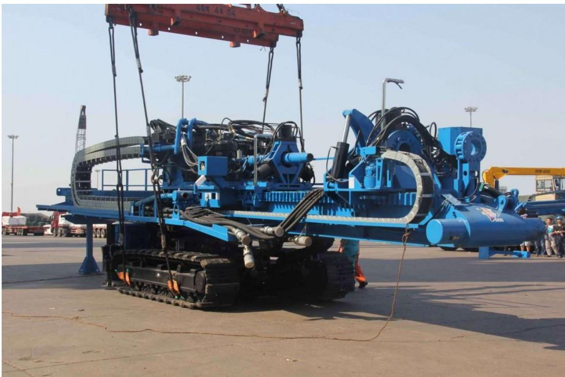
Рисунок 1.11 – Установка горизонтально-направленного бурения DDW-6000
