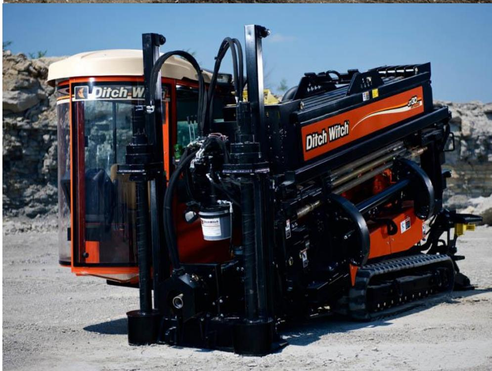
Рисунок 3.6 – Установка горизонтально-направленного бурения JT-30
