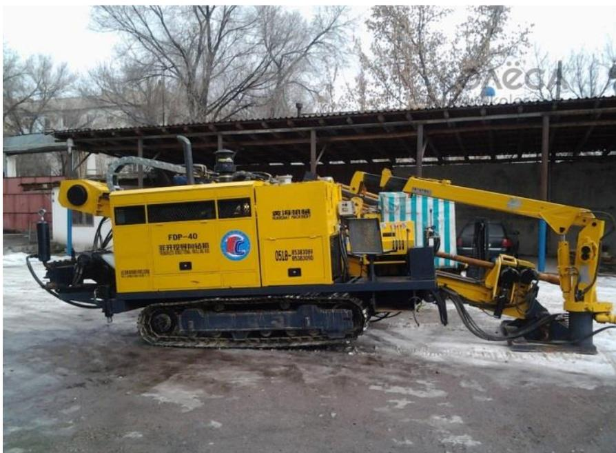
Рисунок 4.3 – Установка горизонтально-направленного бурения FDP-40 (вид сбоку)
