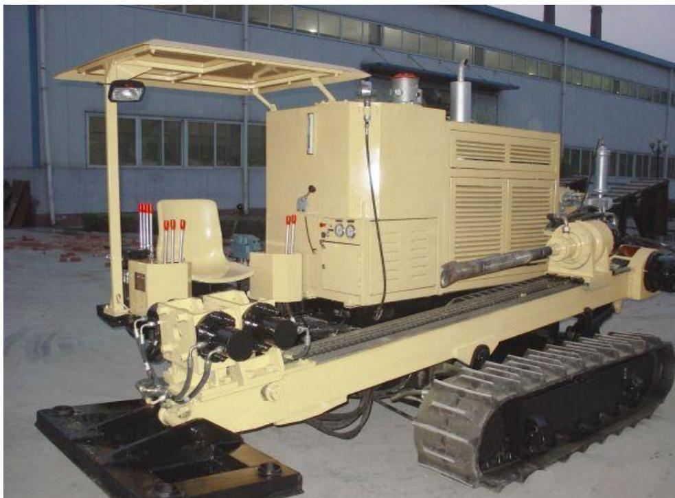
Рисунок 1.1 – Установка горизонтально-направленного бурения DDW-110
