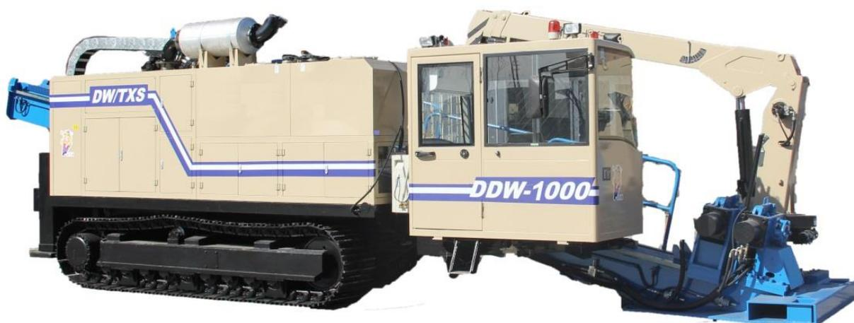
Рисунок 1.7 – Установка горизонтально-направленного бурения DDW-1000
