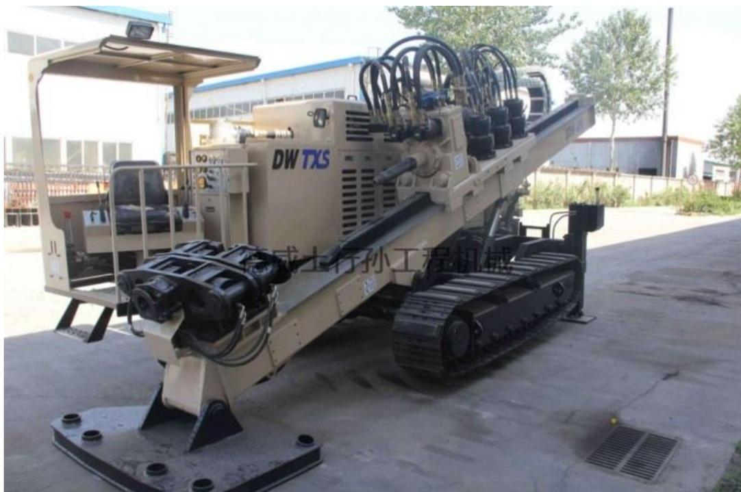
Рисунок 1.4 – Установка горизонтально-направленного бурения DDW-400
