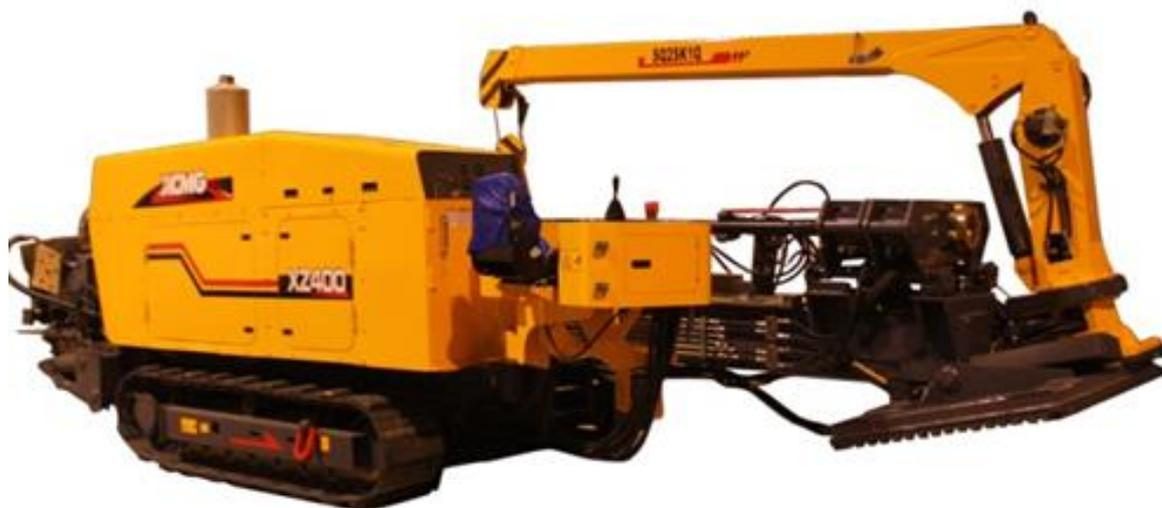
Рисунок 2.5 – Установка горизонтально-направленного бурения XZ-400
