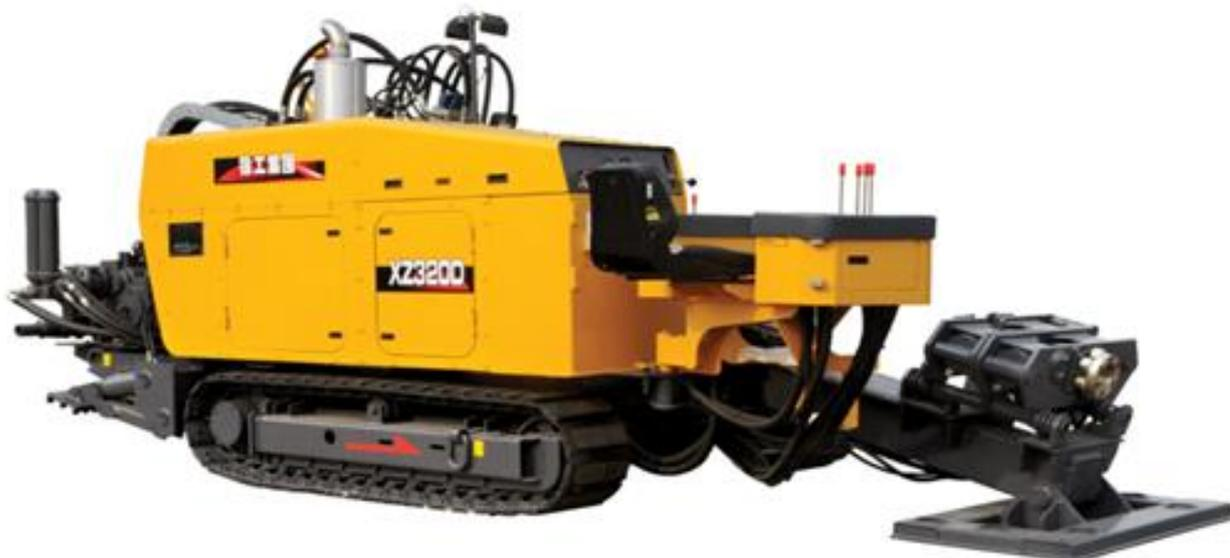
Рисунок 2.4 – Установка горизонтально-направленного бурения XZ-320D
