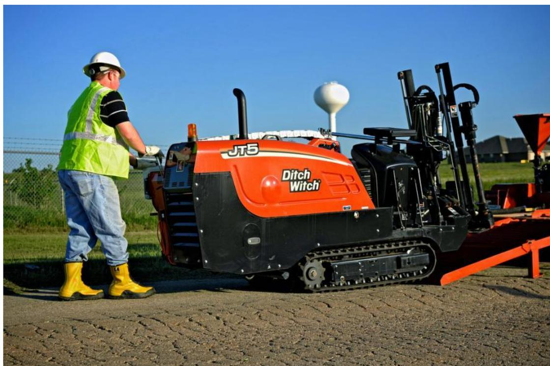
Рисунок 3.1 – Установка горизонтально-направленного бурения JT-5 (погрузка на трал)
