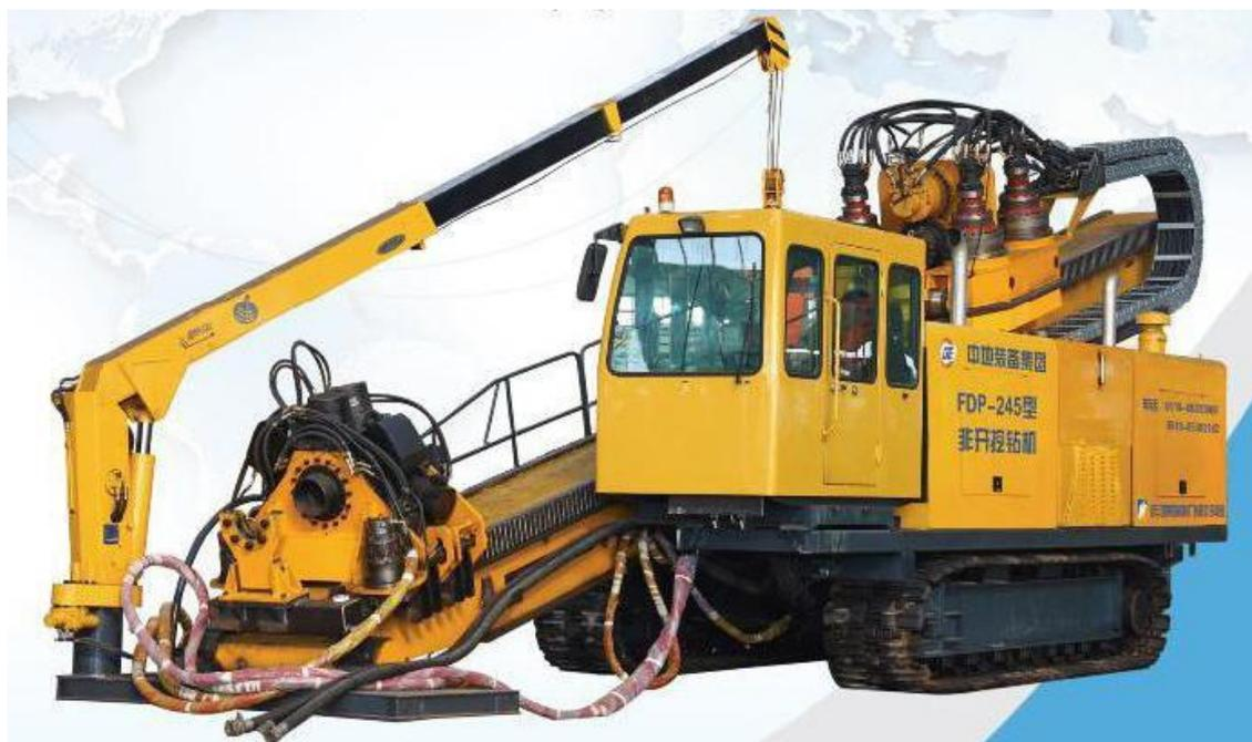
Рисунок 4.6 – Установка горизонтально-направленного бурения FDP-245
