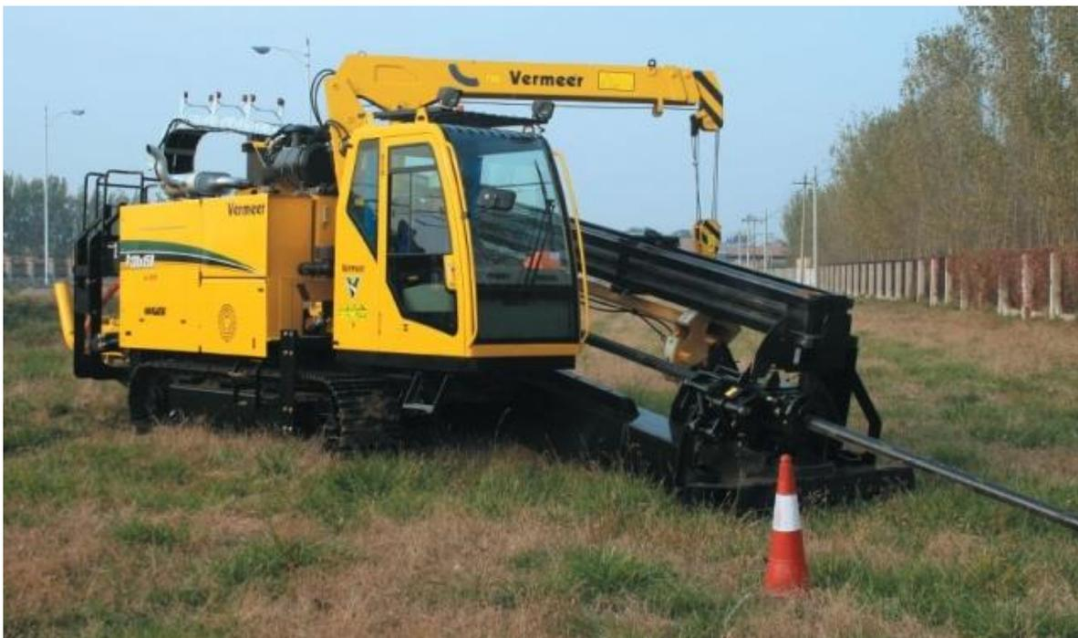
Рисунок 6.10 – Установка горизонтально-направленного бурения D130X150
