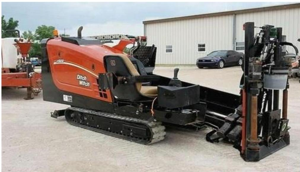
Рисунок 3.3 – Установка горизонтально-направленного бурения JT-922
