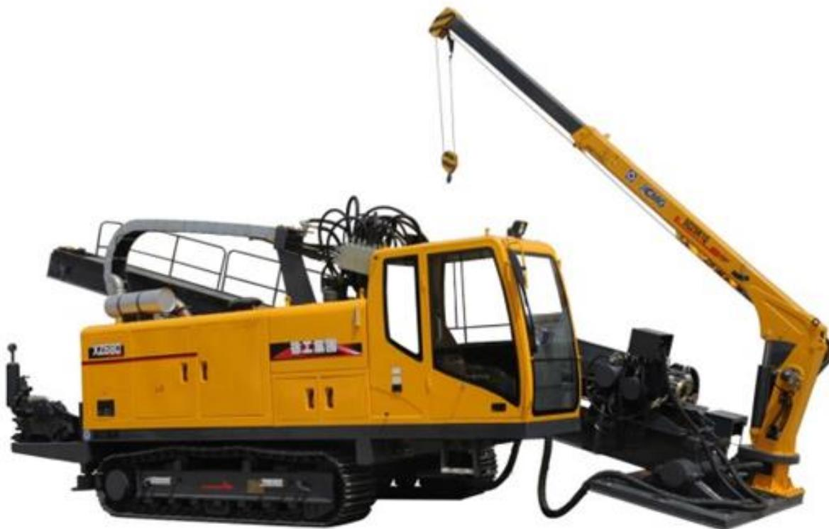
Рисунок 2.8 – Установка горизонтально-направленного бурения XZ-680
