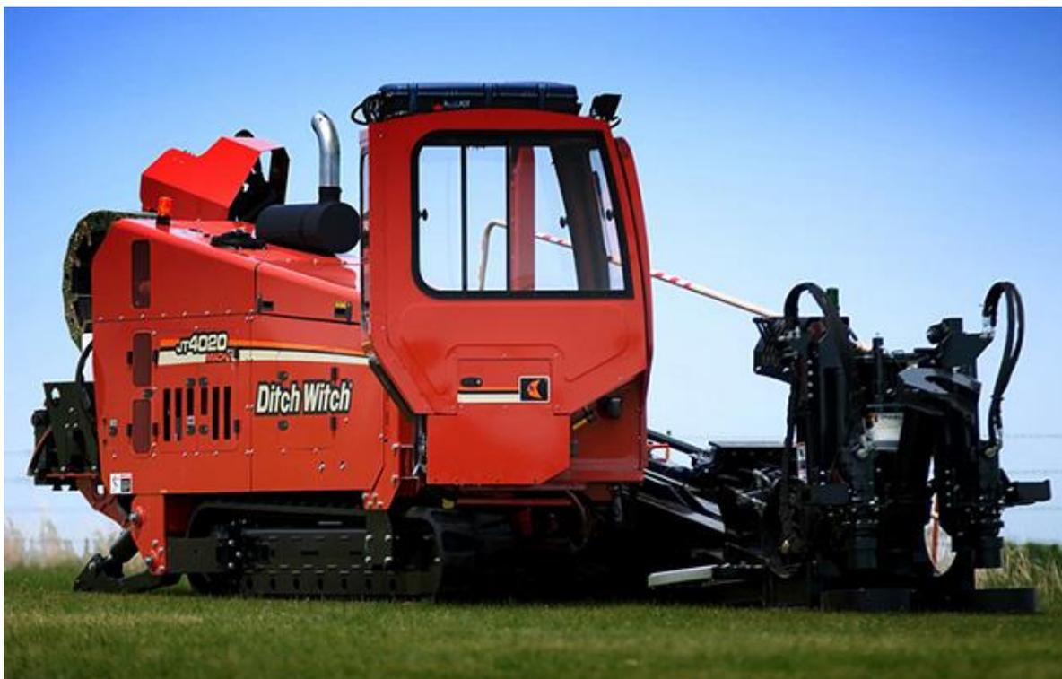
Рисунок 3.7 – Установка горизонтально-направленного бурения JT-4020
