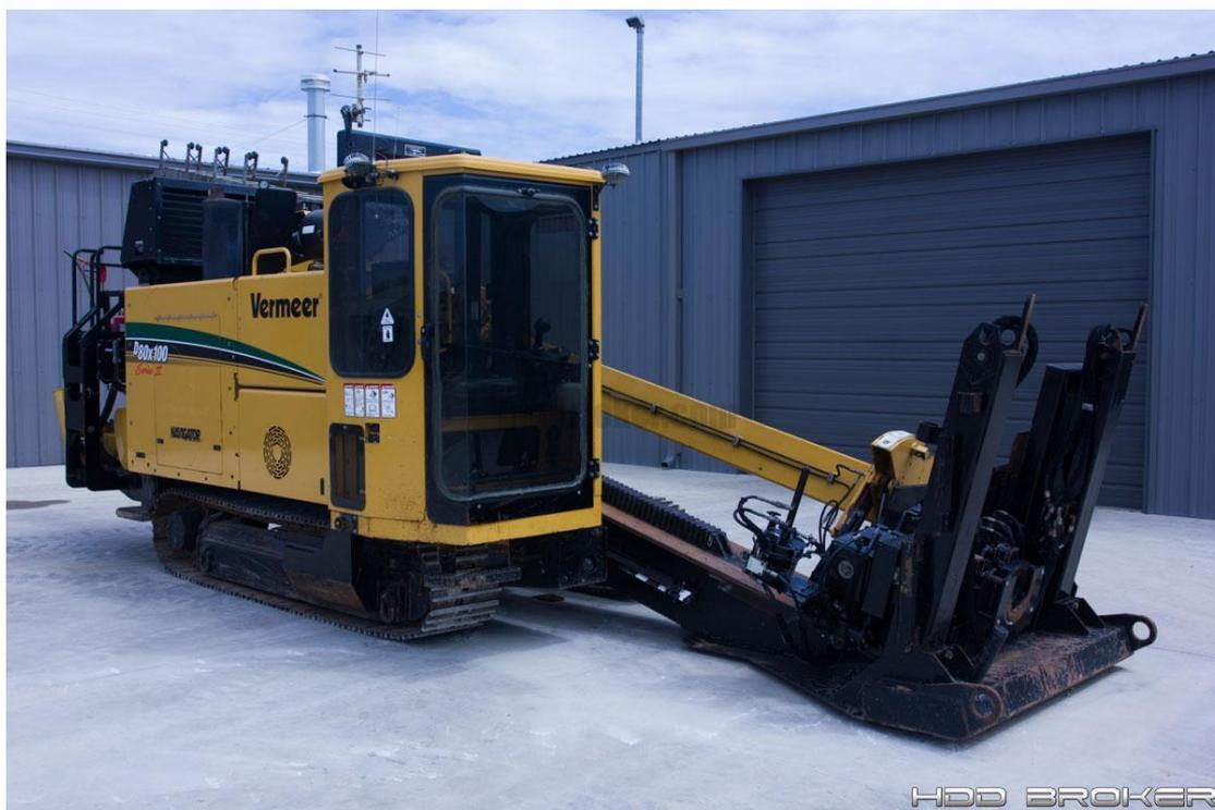
Рисунок 6.7 – Установка горизонтально-направленного бурения D80X100 SERIES II
