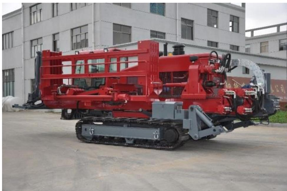
Рисунок 5.4 – Установка горизонтально-направленного бурения FORWARD
