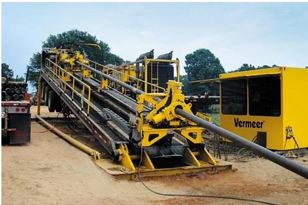
Рисунок 6.13 – Установка горизонтально-направленного бурения D1000X900
