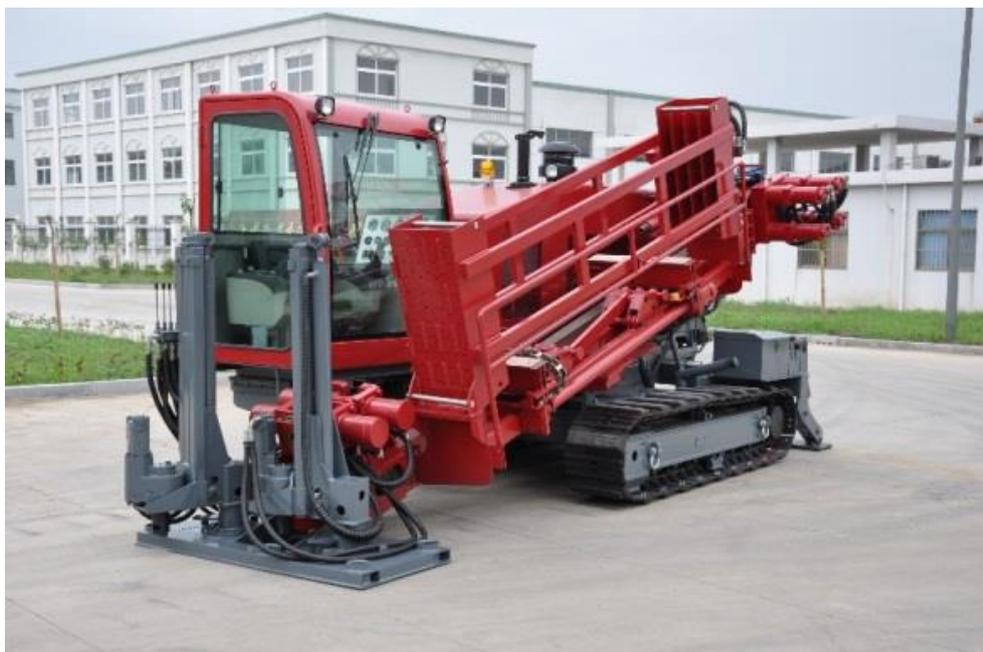
Рисунок 5.3 – Установка горизонтально-направленного бурения FORWARD
