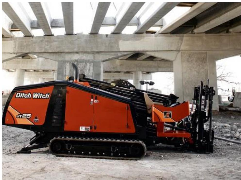
Рисунок 3.5 – Установка горизонтально-направленного бурения JT-25
