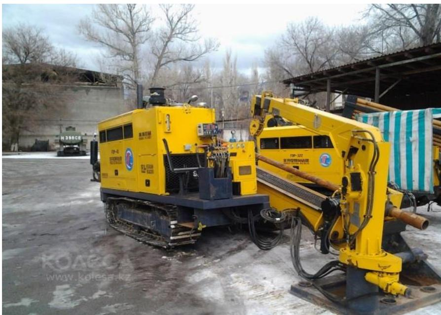
Рисунок 4.2 – Установка горизонтально-направленного бурения FDP-40
