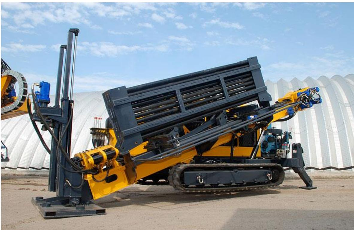
Рисунок 4.1 – Установка горизонтально-направленного бурения FDP-20/20Z
