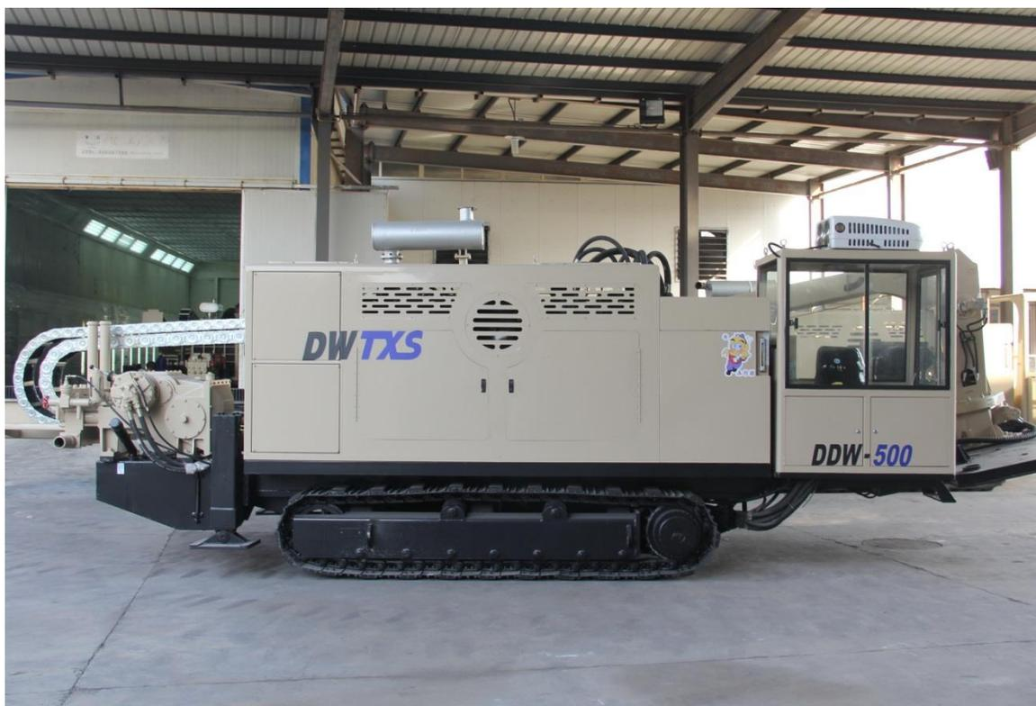
Рисунок 1.5 – Установка горизонтально-направленного бурения DDW-500
