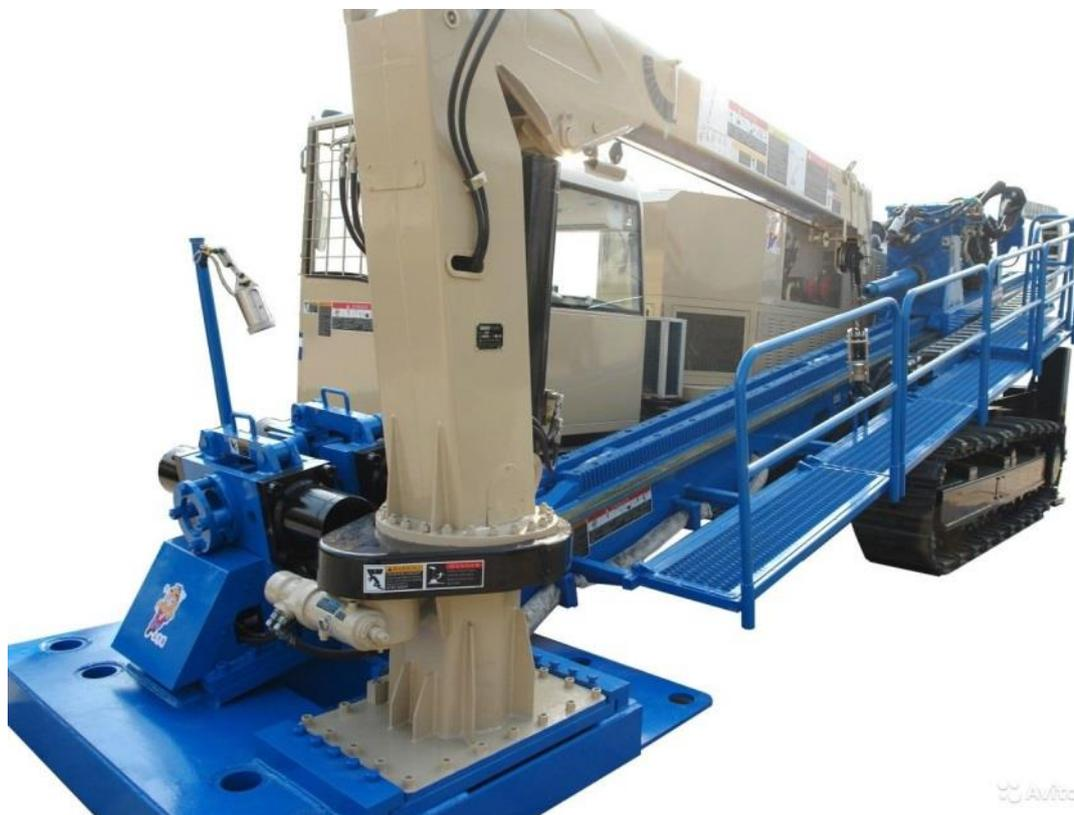
Рисунок 1.6 – Установка горизонтально-направленного бурения DDW-600
