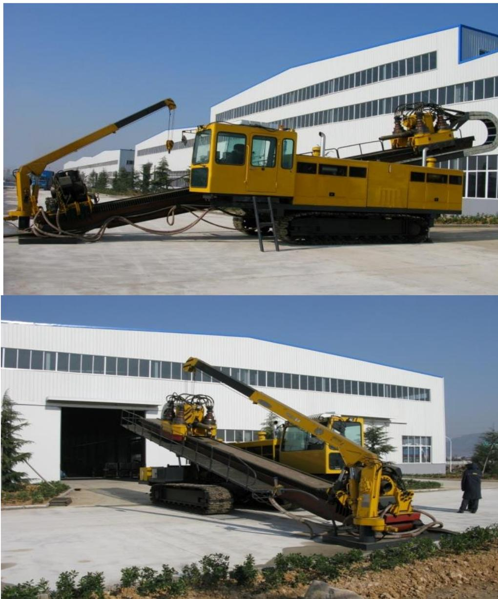
Рисунок 4.5 – Установка горизонтально-направленного бурения FDP-120
