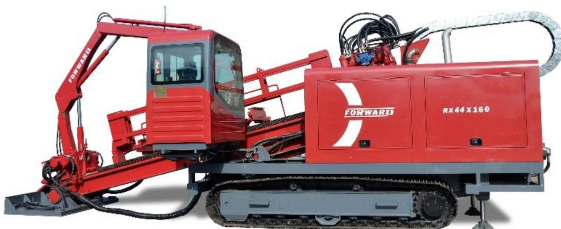
Рисунок 5.5 – Установка горизонтально-направленного бурения FORWARD RX44x160 (вид сбоку)
