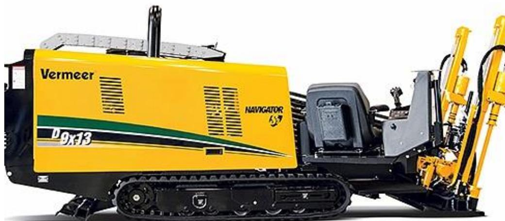
Рисунок 6.2 – Установка горизонтально-направленного бурения D9X13 S3
