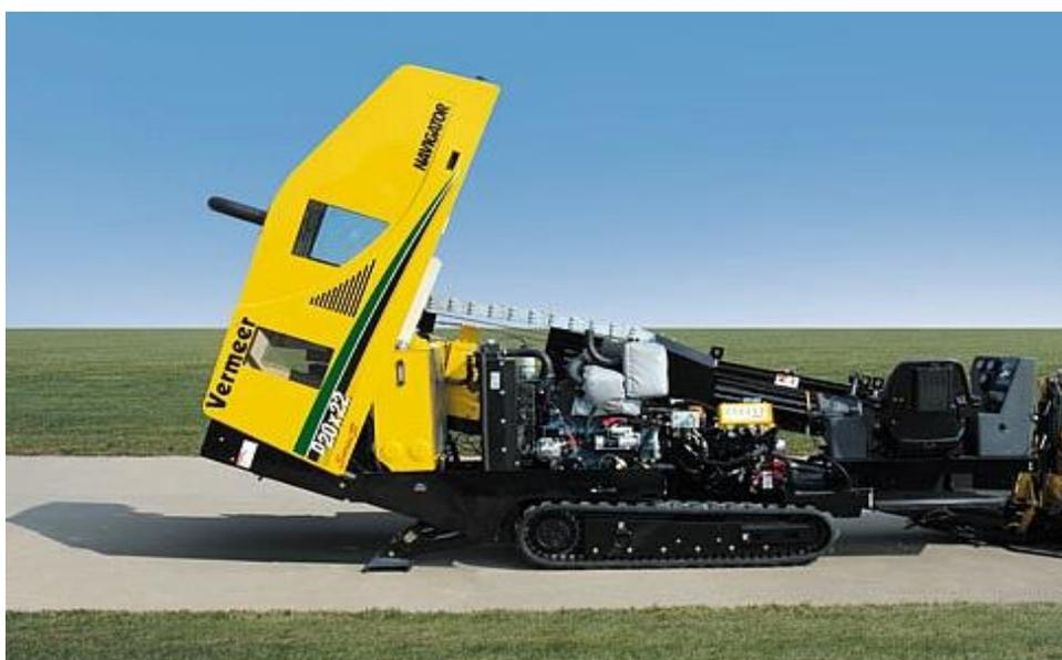
Рисунок 6.3 – Установка горизонтально-направленного бурения D20X22 SERIES II
