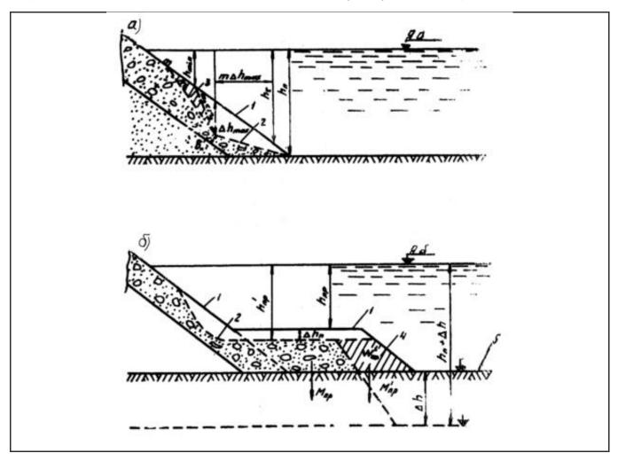
Рис. 1. Схема деформации наброски на откосе: а - конструкция укрепления при отсутствии размывов дна русла; б - то же при размывах дна русла. 1 - поперечное сечение откоса до размыве; 2 - то же после размыва; 3 - участок скатывании и камней с откоса; 4- часть призмы, разрушаемая при размыве дна; 5 - дно после размыва
