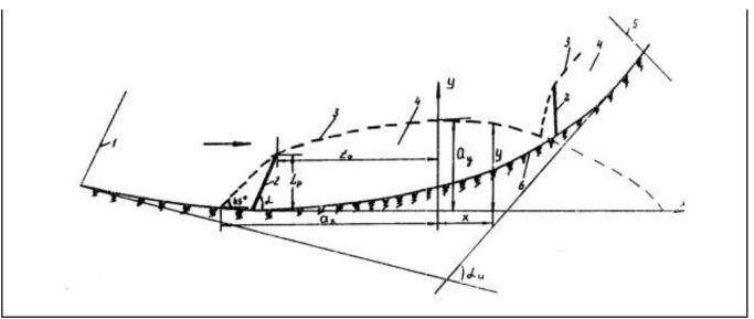
Рис. 7. Размеры водоворотных зон у поперечных сооружений: 1 - начало излучины; 2 - поперечные сооружения;
