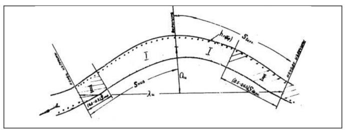
Рис 1. Схема к определению глубин потока у вогнутого берега
