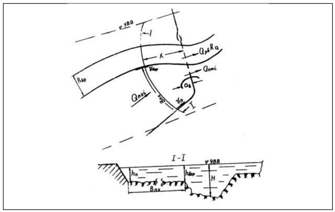
Рис.6 . К определению скорости потока  $v_{\rm n}$  у пойменной насыпи
