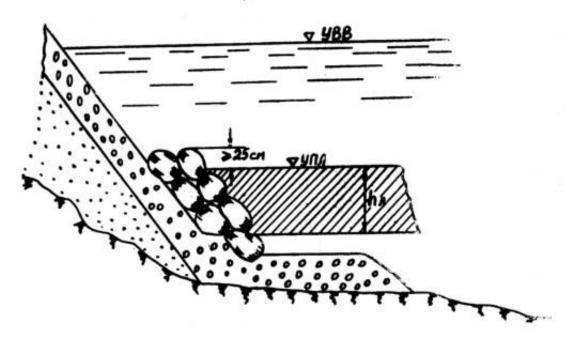
Рис. 3. Укрепление откоса наброской при ледовых воздействиях
