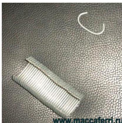
1.9 В закрытом состоянии диаметр кольца примерно равен 20 мм; максимальный шаг между кольцами при скреплении сетки должен составлять не более 20 см. Примерное количество колец, необходимых для связывания элементов конструкций приведено в Таблице 1:
