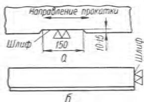
Рис. 53. Расположение шлифов для снятия микроструктуры по способу Баумана:
