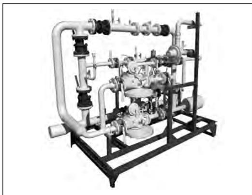
**Газорегуляторные установки с узлом учета газа ГРУ-13-2НВ-У,** с двумя основными и двумя резервными линиями редуцирования и разными регуляторами на среднее и низкое выходное давление при параллельной установке регуляторов
