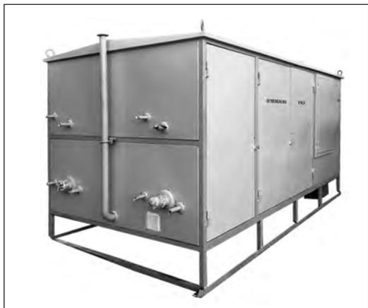
**Газорегуляторные пункты шкафные с узлом учета газа ГРПШ-13-2НВ-У1,** с двумя основными и двумя резервными линиями редуцирования и разными регуляторами на среднее и низкое выходное давление при параллельной установке регуляторов
