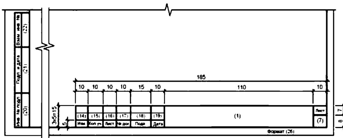
Примечание — Основную надпись по форме 6 допускается использовать для последующих листов графических документов по инженерным изысканиям, не используемых в проектировании в качестве графической основы.
