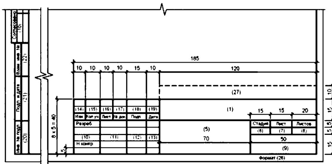
Примечание — Основную надпись по форме 5 допускается использовать для графических документов по инженерным изысканиям, не используемых в проектировании в качестве графической основы.
