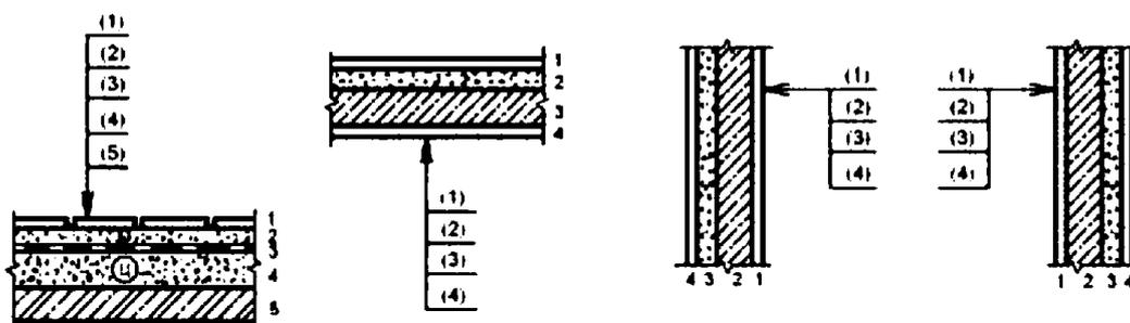
**Примечание** — Цифрами условно обозначена последовательность расположения слоев конструкций и надписей на полках линий-выносок.
