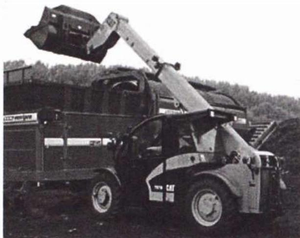
Рис. 4.5. Погрузчик с телескопической стрелой
