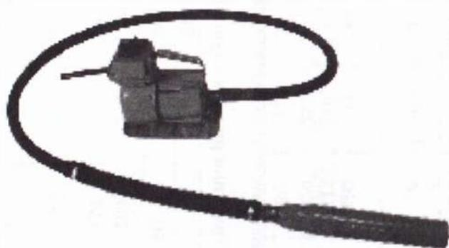
Рис. 4.10. Глубинный вибратор
