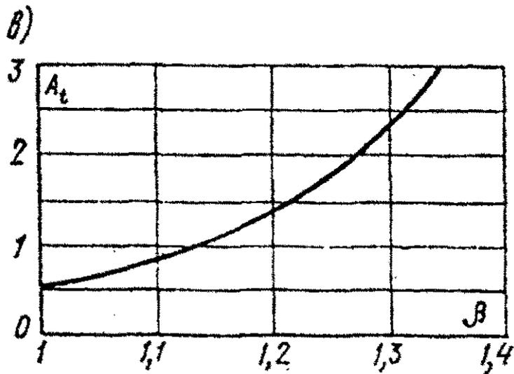
Рис. 2. Зависимость коэффициента  $\beta$  от параметра  $A_t$
