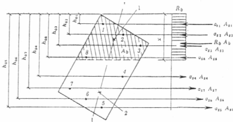
Черт. 8. Схема усилий и эпюра напряжений в сечении, нормальном к продольной оси железобетонного элемента, в общем случае расчета по прочности  $I-I$  — плоскость, параллельная плоскости действия изгибающего момента, или плоскость, проходящая через точки приложения продольной силы и равнодействующих внутренних сжимающих и растягивающих усилий; 1 — точка приложения равнодействующей усилий в сжатой арматуре и в бетоне сжатой зоны; 2 — точка приложения равнодействующей усилий в растянутой арматуре
