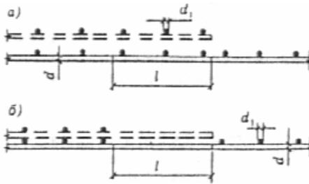
Черт. 25. Стыки сварных сеток внахлестку (без сварки) в направлении рабочей арматуры, выполненной из стержней периодического профиля
