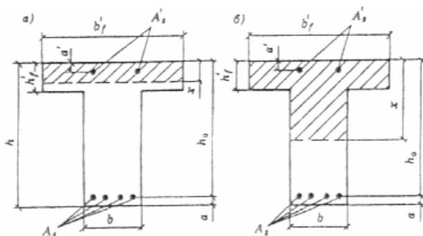
Черт. 5. Положение границы сжатой зоны в сечении изгибаемого железобетонного элемента
