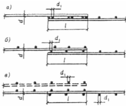
Черт. 24. Стыки сварных сеток внахлестку (без сварки) в направлении рабочей арматуры, выполненной из гладких стержней
