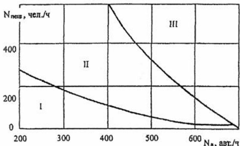
I – нерегулируемые переходы; II – переходы со светофорным регулированием;
