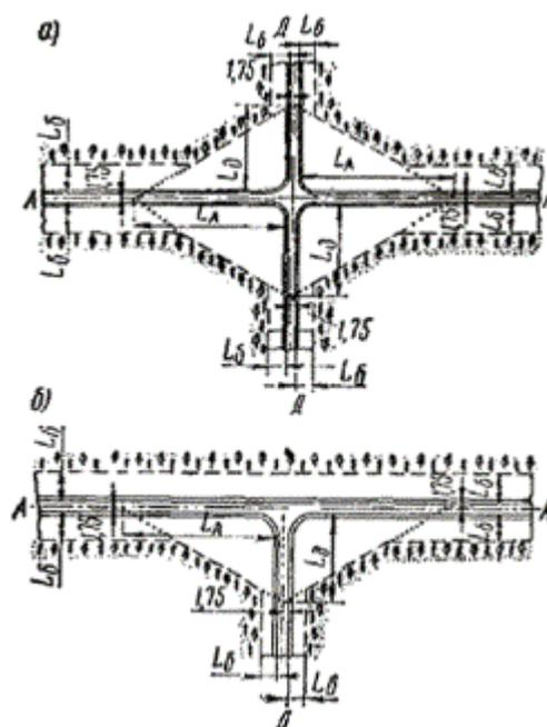
*a* - на пересечениях автомобильных дорог в одном уровне;
