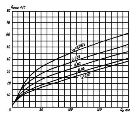
Зависимость расхода решетки московского типа от расхода в лотке и продольного уклона лотка дождеприемник с отверстием в вертикальной плоскости бордюрного камня:
