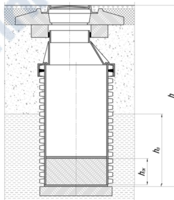
Принимается, что при всплытии колодец движется равномерно без ускорения, значит сумма всех действующих на него сил равна нулю:
