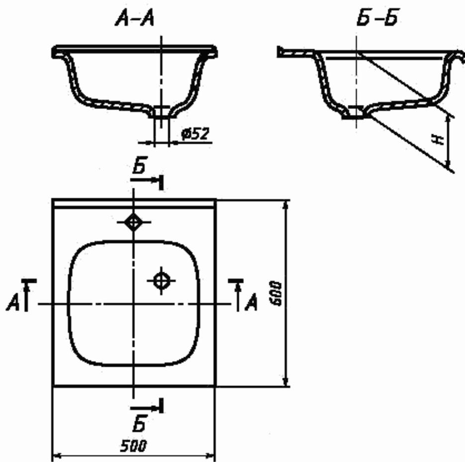
Рисунок 7 — Мойка чугунная эмалированная с одной чашей
