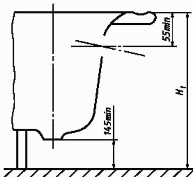
Рисунок 6 — Установочные размеры ванны и поддона
