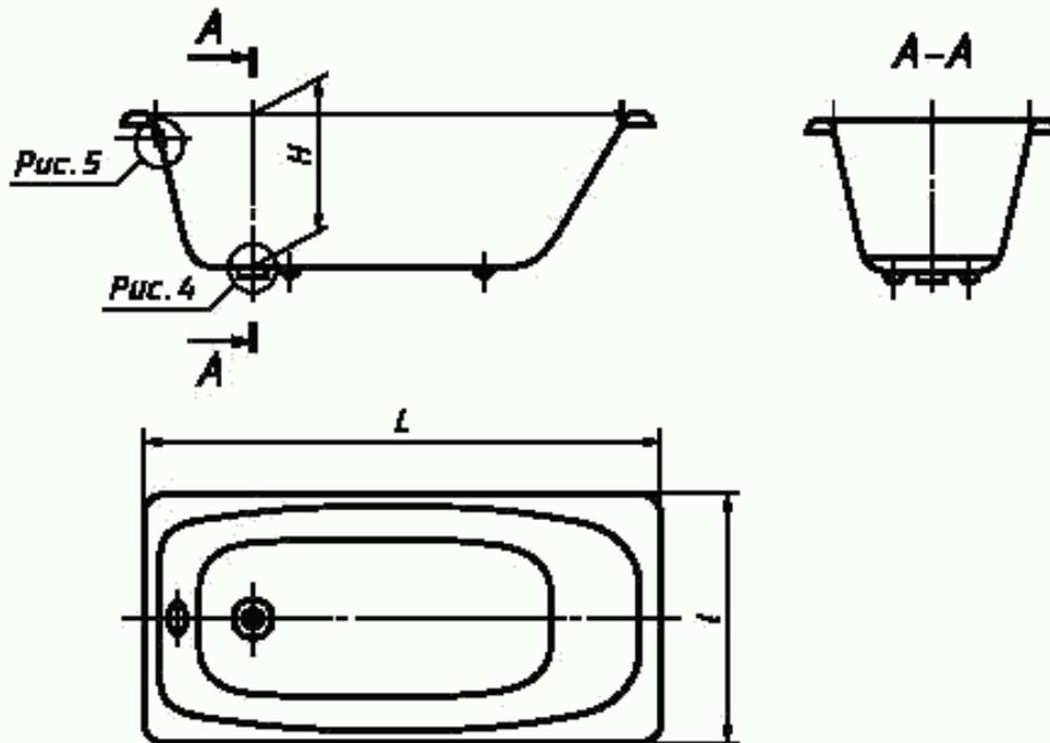
Рисунок 1 — Ванна чугунная эмалированная
