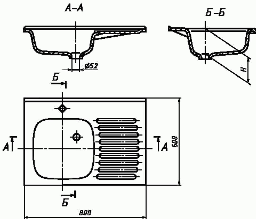
Рисунок 8 — Мойка чугунная эмалированная со сливной полкой
