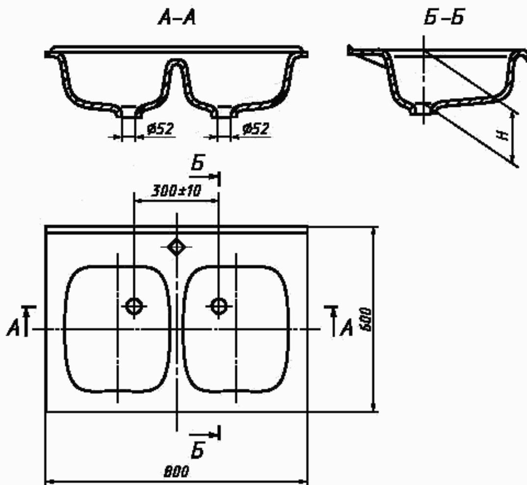
Рисунок 9 — Мойка чугунная эмалированная с двумя чашами
