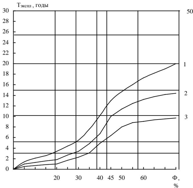
Рис. 3. Физический износ системы внутреннего горячего водоснабжения
