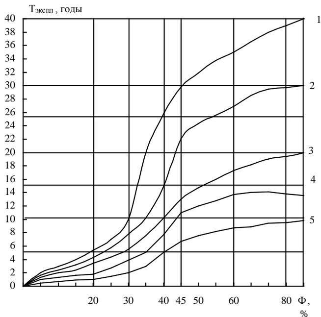
Рис. 6. Физический износ системы внутренней канализации
