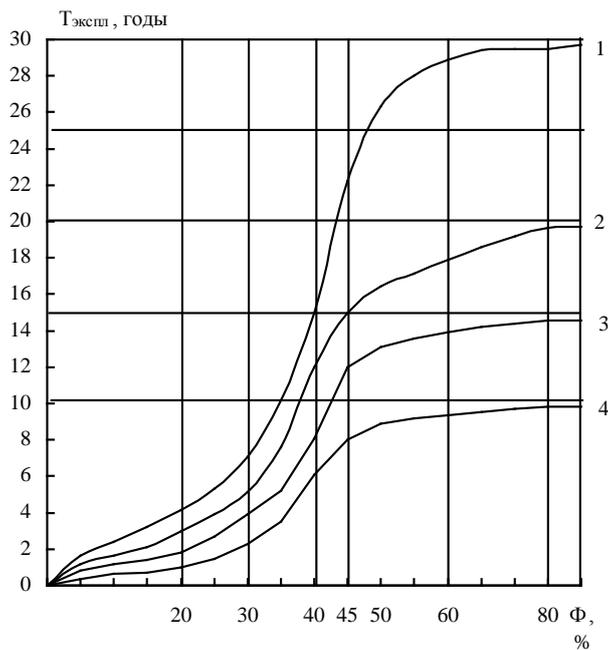
Рис. 5. Физический износ системы внутреннего водопровода
